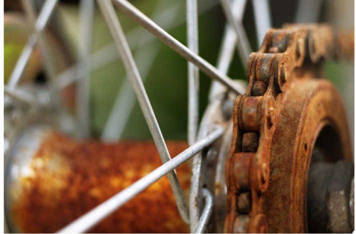
Obr. 8 Ukázka koroze zadního náboje bicyklu [27]
