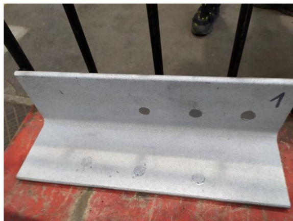
Obr. 60 Vzorek 1 po přilnavostní zkoušce
