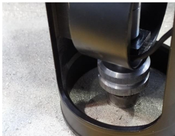
Obr. 56 Zašroubování odtrhoměru do terče
