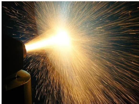
Obr. 1 Žárový nástřik elektrickým obloukem [6]
