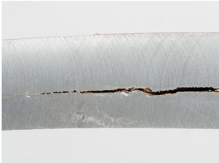
Obr. 17 Narušení materiálu vlivem korozního praskání [39]
