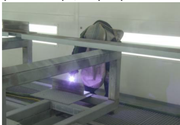
Obr. 49 Aplikace žárového nástřiku
