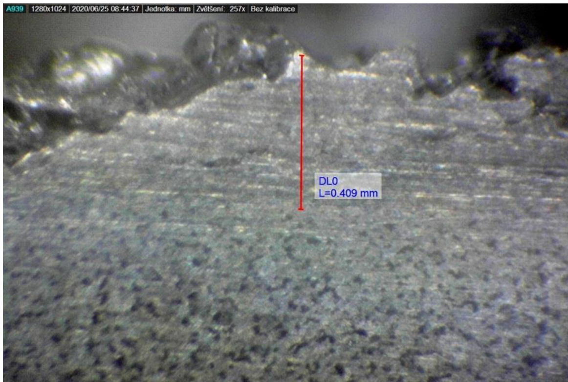
Obr. 82 Homogenní povlak s velmi dobrou vazbou na základní materiál – vzorek č. 4
