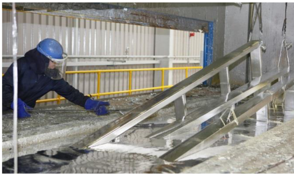
Obr. 4 Proces žárového zinkování [19]
