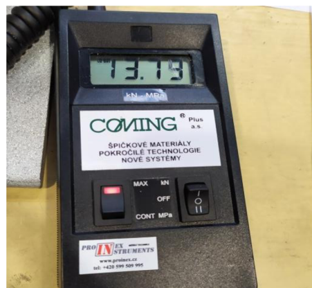
Obr. 58 Výsledná hodnota na displeji
