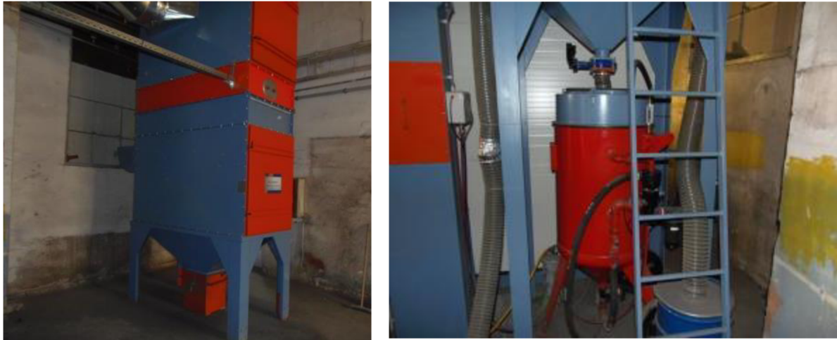
Obr. 43 a 44 Tryskací zařízení Airblast ABSC-200
