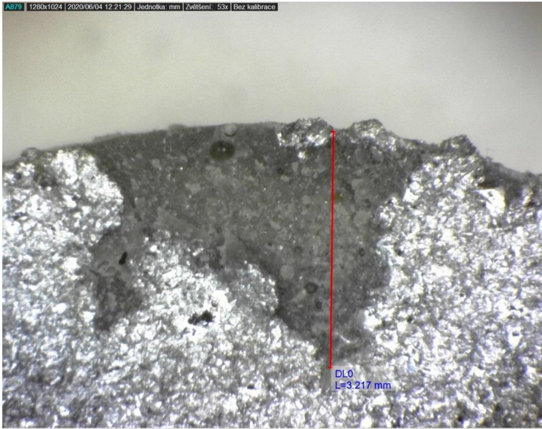
Obr. 64 Detail zbytku lepidla na terči pro vzorek č. 4
