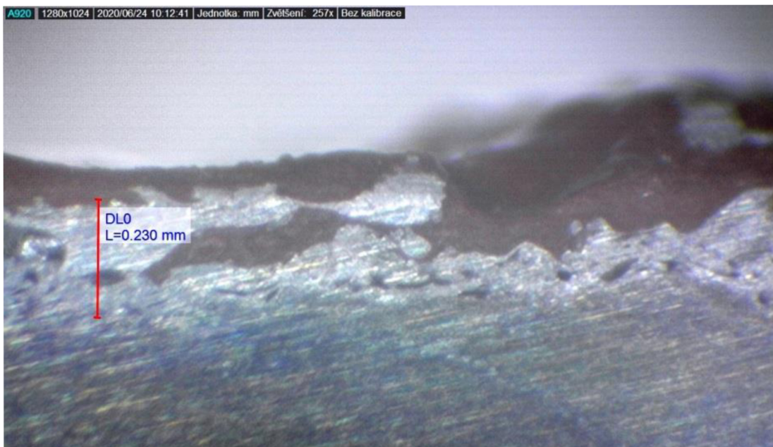
Obr. 81 Snímek, zobrazující velký pór povlaku – vzorek č. 2
