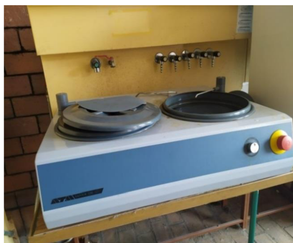
Obr. 77 Metalografická bruska pro úpravu vzorku
