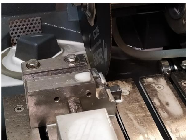
Obr. 76 Dělení vzorku na metalografické pile
