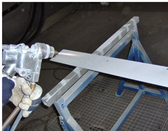
Obr. 2 Nanesení povlaku Zinacor 850 [3]
