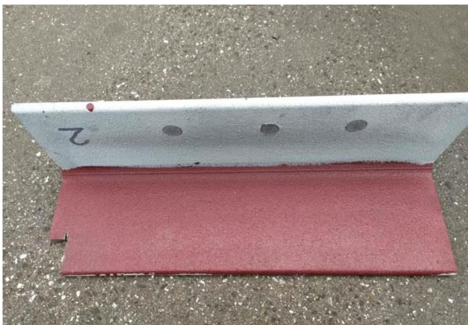
Obr. 78 Nanesená vrstva nátěru na povlaku Zinacor 850
