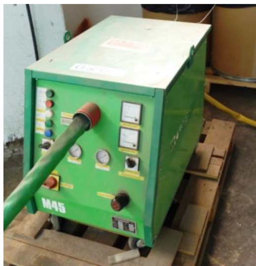
Obr. 48 Metalizační zařízení MARGARIDO M45
