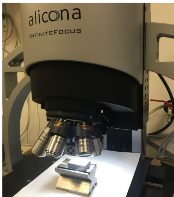
Obr. 69 Měření drsnosti na zařízení Alicona
