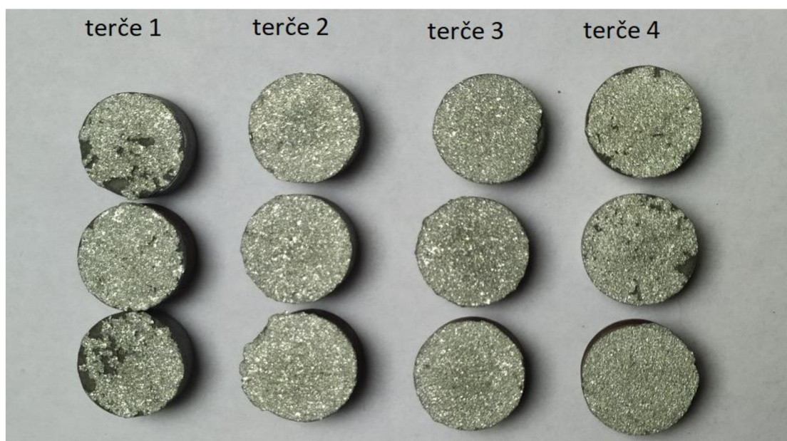
Obr. 62 Vizuální srovnání odtržených ploch terčů pro měření přilnavosti povlaku
