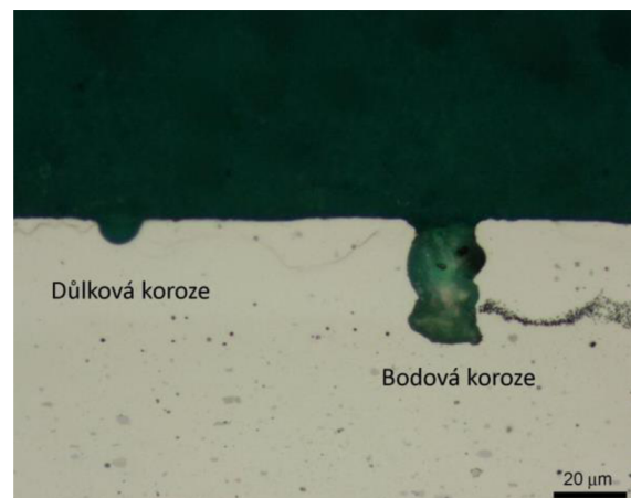
Obr. 12 Důlková a bodová koroze [34]
