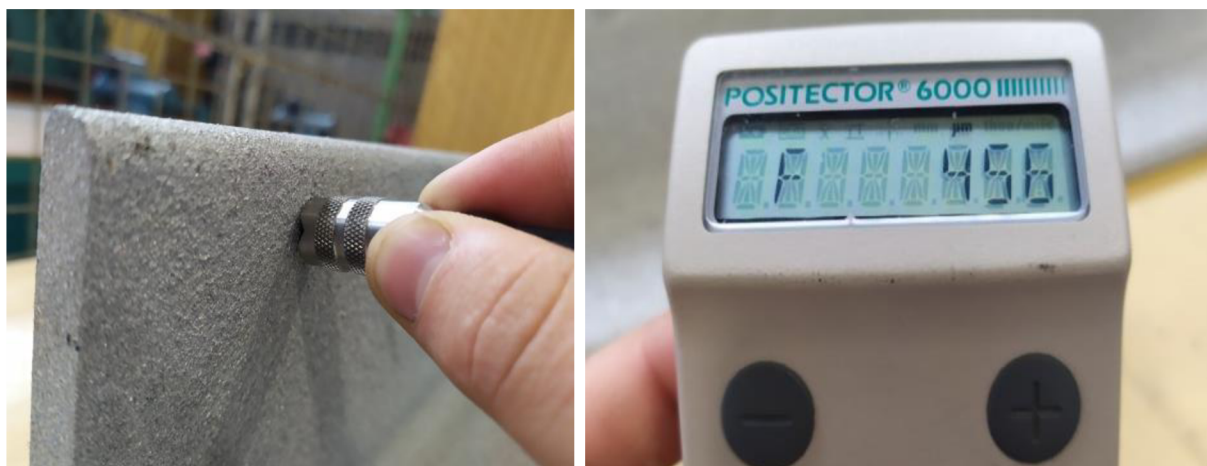
Obr. 52 a 53 Měření tloušťky povlaku
