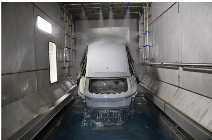
Obr. 20 Fosfátování karoserie Škoda [44]
