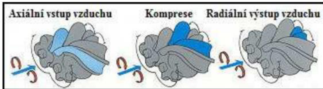
Obr. 5 Schéma a princíp fungovania Lysholmovho dúchadla [8]
