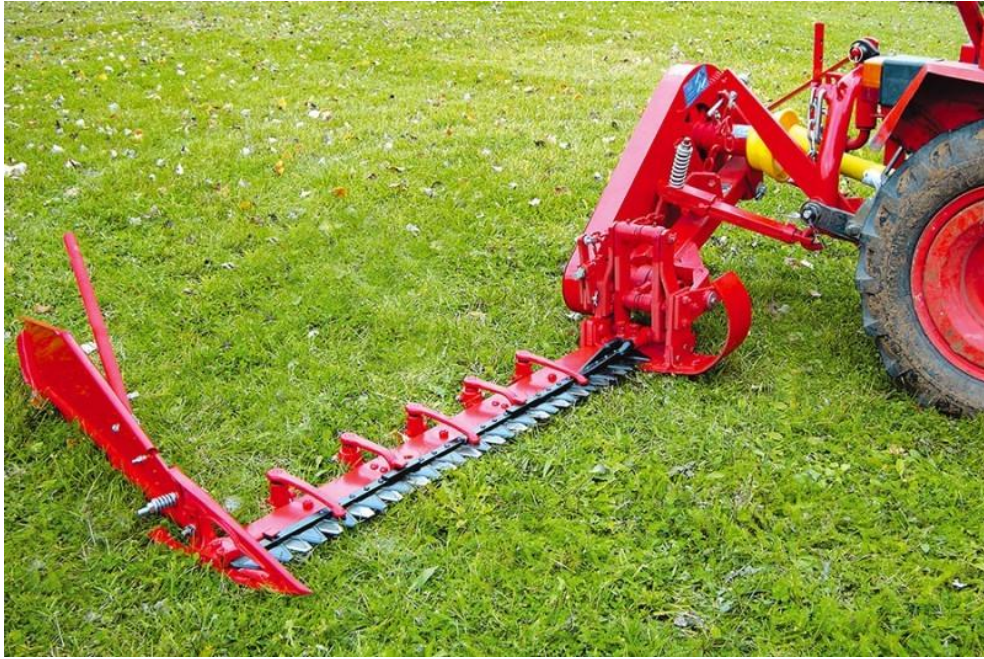
Obrázek 4.2: Protiběžná žací lišta
