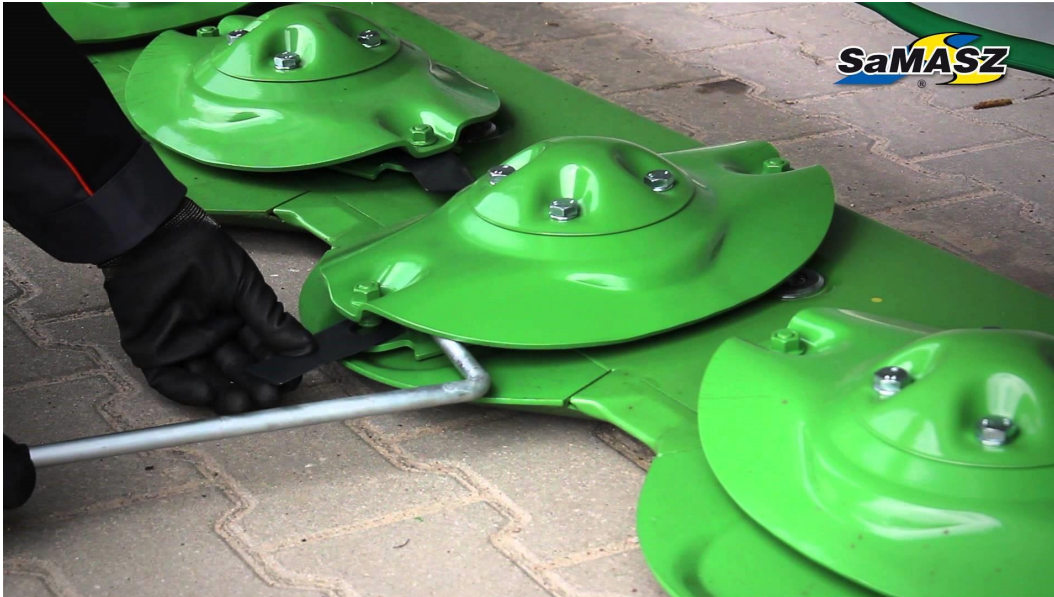
Obrázek 4.7: Výměna nože pomocí speciální páky
