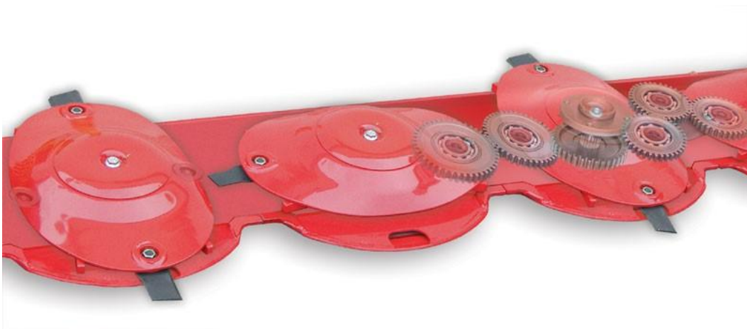
Obrázek 4.8: Pohon ozubenými koly s čelním ozubením
