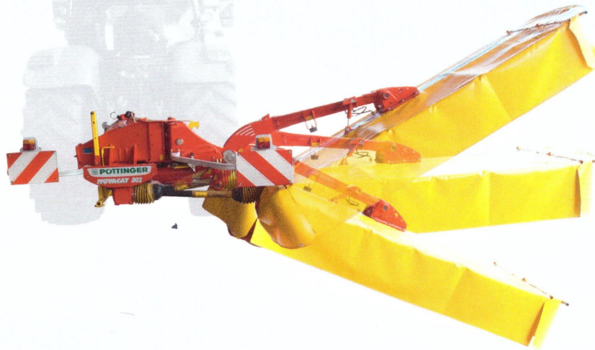
Obrázek 5.7: Maximální kopírovací úhel
