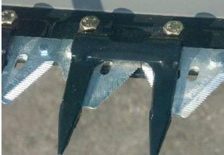
Obrázek 4.1: Detail prstové žací lišty
