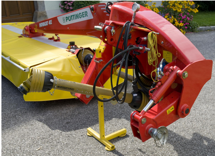
Obrázek 5.6: Hydraulický válec závěsu stroje
