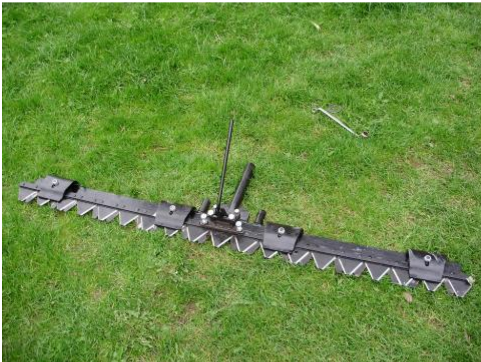
Obrázek 4.3: Bezprstová žací lišta pro malotraktor MF-70
