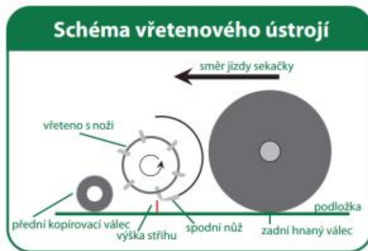
Obrázek 4.12: Schéma vřetenového žacího ústrojí
