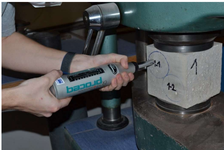
Obrázek 14: Stanovení hodnot odrazu přístroje Schmidt typu N (archiv P.Cikrle)
