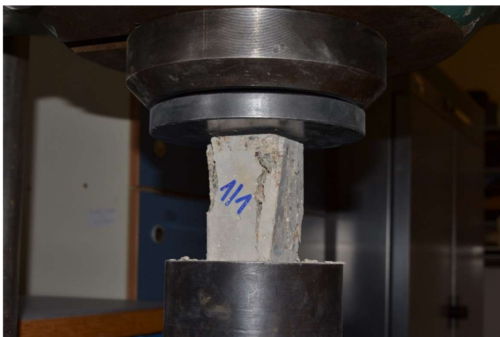
Obrázek 28: Porušení kvádru při stanovení maximální síly (archiv P.Cikrle)
