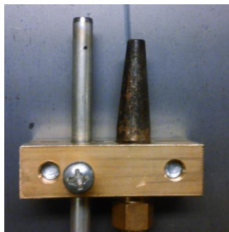
Obr.3.4: Nastavení dorazu pro plamenový hořák
