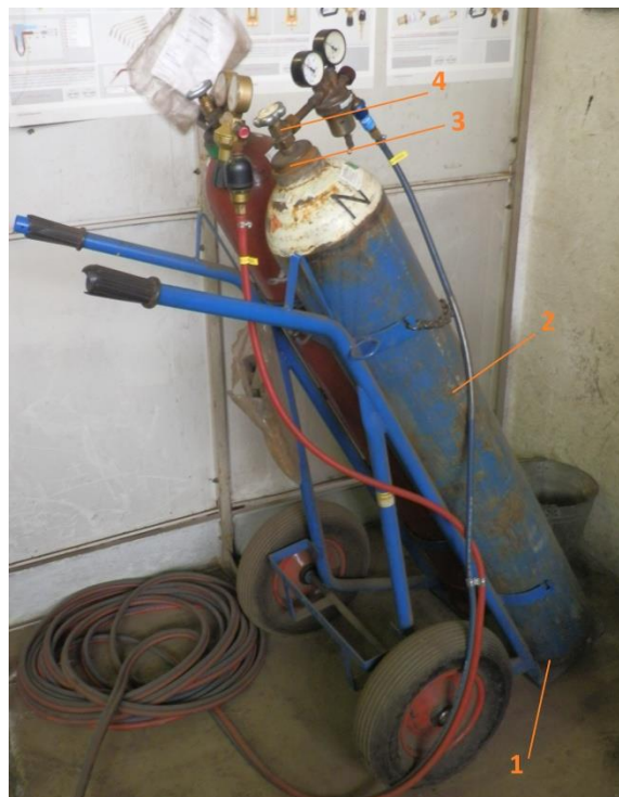
Obr.2.18: Tlaková lahev – 1- patka, 2 - těleso lahve, 3 - hrdlový kroužek, 4 - lahvový ventil
