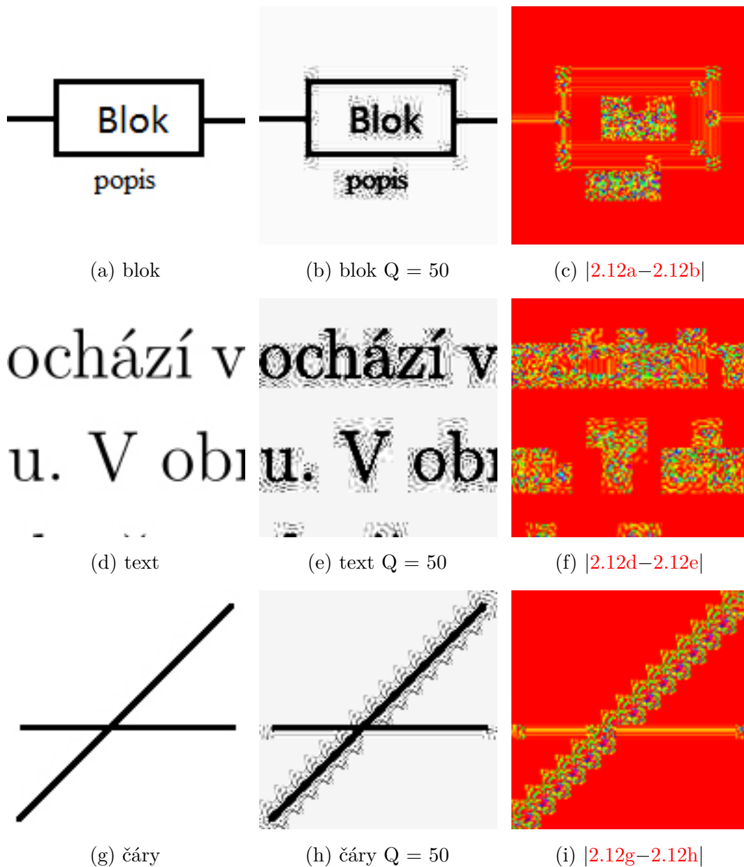
Obr. 2.12: Zobrazení rozdílu mezi originálem a degradovaným obrázkem. V prvním sloupečku lze nalézt originální obrázky, ve druhém sloupci se nachází originální obrázky zakódované pomocí JPEG s nastavenou kvalitou Q na hodnotu 50. Poslední sloupec reprezentuje rozdíl v absolutní hodnotě mezi originálem a komprimovaným obrázkem. Pro lepší viditelnost rozdílů byla pro vykreslení využita funkce imagesc z matlabu . Vytvořeno pomocí funkce s názvem „demo_zobrazeni_rozdilu_mezi_originalem_a_degradovanim.m“ uložené v adresáři vytvořeno. Obrázky 2.12b, 2.12e a 2.12h byly upraveny v aplikaci Adobe Photoshop pro lepší viditelnost vzniklých artefaktů v tištěné verzi této práce. Porovnání původního obrázku s upraveným znázorňuje obrázek A.1.
