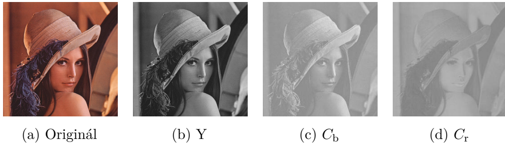
Obr. 2.5: Barevná transformace z RGB do YC_bC_r s podvzorkováním 4:2:2. Vlevo se nachází původní obrázek 2.5a, následovaný lumenční složkou 2.5b a složkami chrominančními 2.5c a 2.5d.
