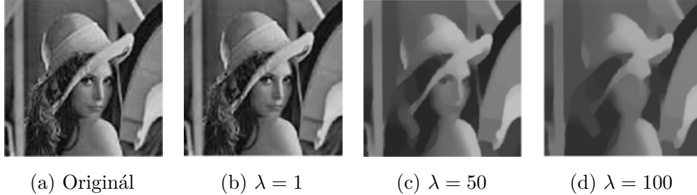
Obr. 4.2: Znázornění vlivu regularizačního parametru \lambda na rekonstrukci obrazu. Výsledky získané pomocí vytvořené funkce s názvem „demo_vliv_lambda.m“, která je umístěna v adresáři vytvořeno.
