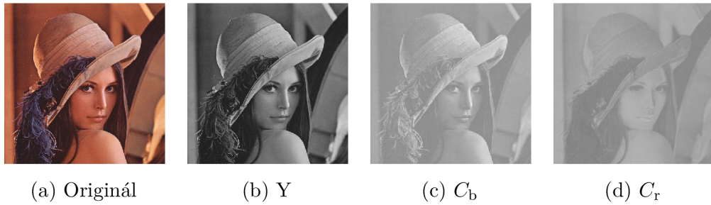
Obr. 2.5: Barevná transformace z RGB do YC b C r s podvzorkováním 4:2:2. Vlevo se nachází původní obrázek 2.5a, následovaný luminanční složkou 2.5b a složkami chrominančními 2.5c a 2.5d.
