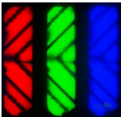
Obrázek 11 Mikroskopický pohled na subpixely S-PVA technologie
