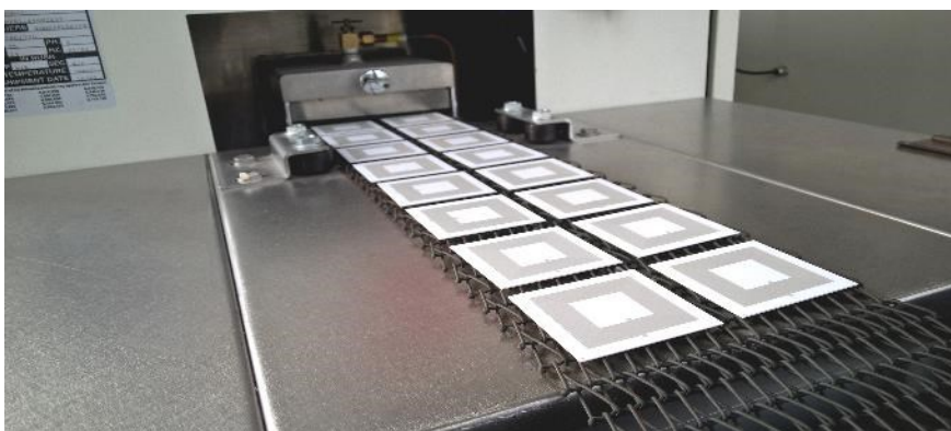
Obr. 4-22: Vzorčky před výpalem v in-line peci
