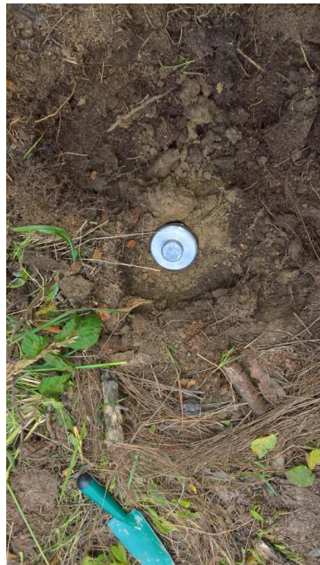
Příloha 13 Postup při odběru fyzikálního válečku
