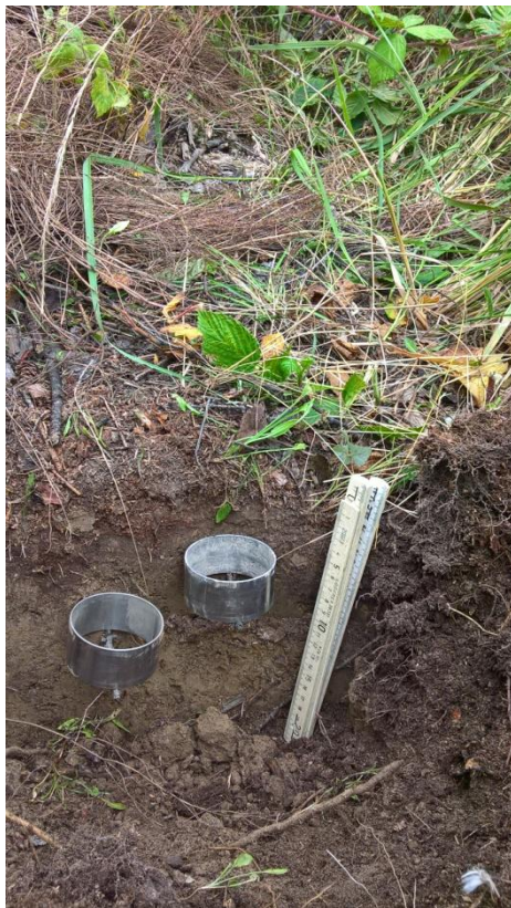
Příloha 12 Odběr fyzikálních válečků
