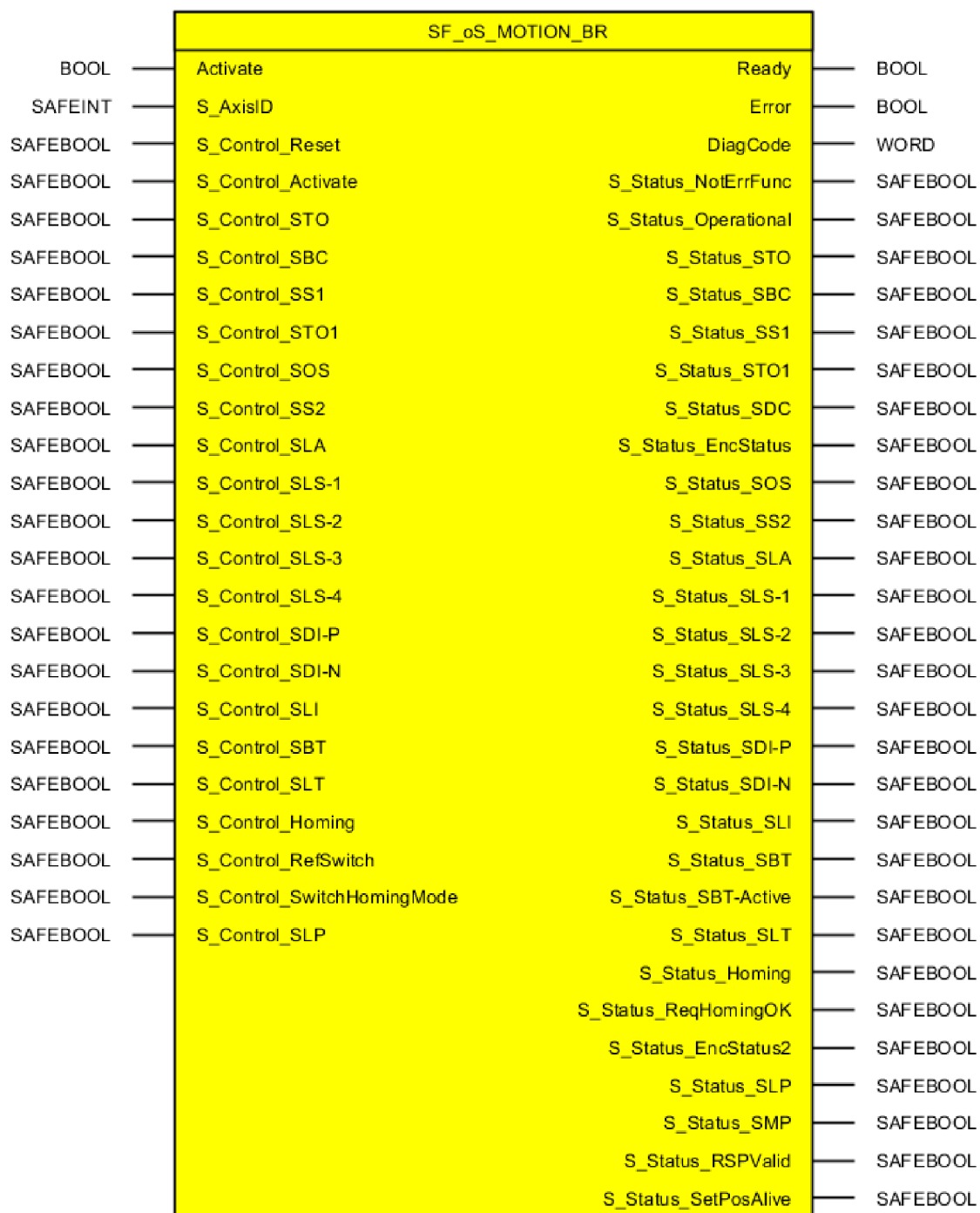
Obrázek 5.1: Funkční blok SF_oS_MOTION_BR
