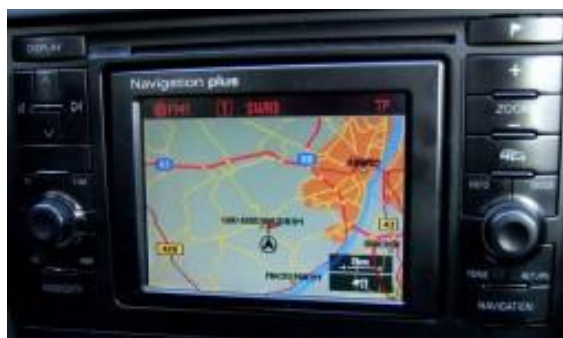
Obr. 4: Vestavěný přístroj na příjem RDS-TMC Inc. dne 22. 1. 2015.
