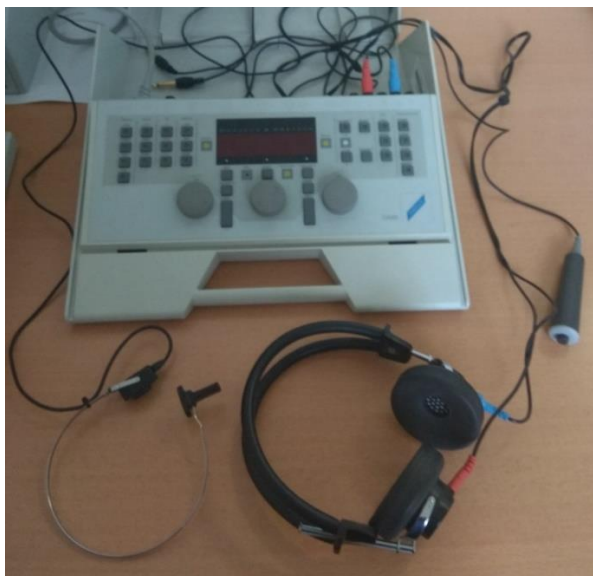
Obrázek 3.3 Audiometr, sluchátka, kostní vibrátor a signalizační tlačítko
