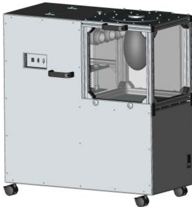
Obr. 2.1: Mechanický plicní simulátor i-Lung 2.0. (Převzato z: [2])
