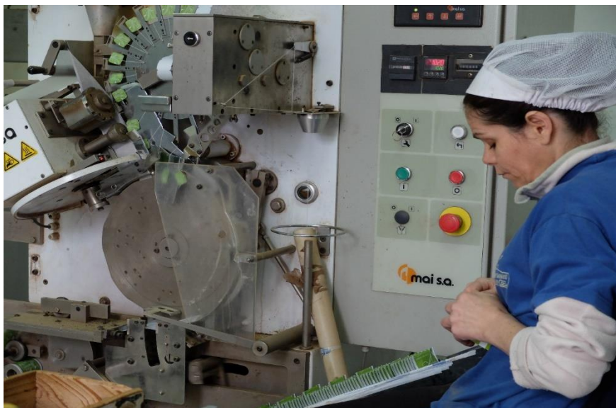
Obrázek 13: Balení černého čaje do sáčků v továrně Chá Gorreana Zdroj: autorka
