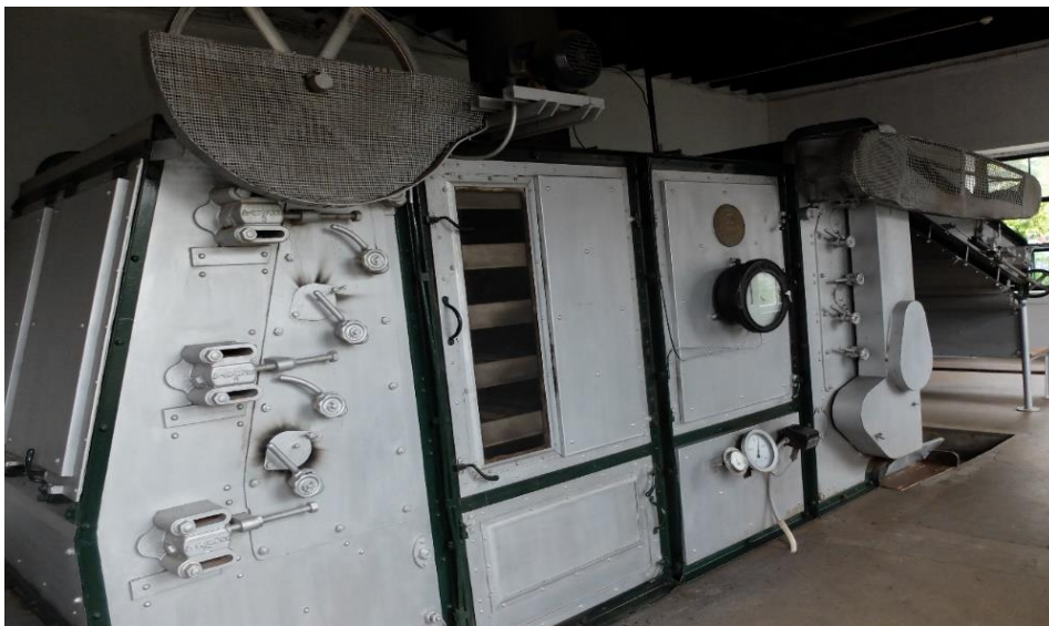
Obrázek 12: Sušení čajových lístků v Chá Gorreana za pomoci sušičky Zdroj: autorka
