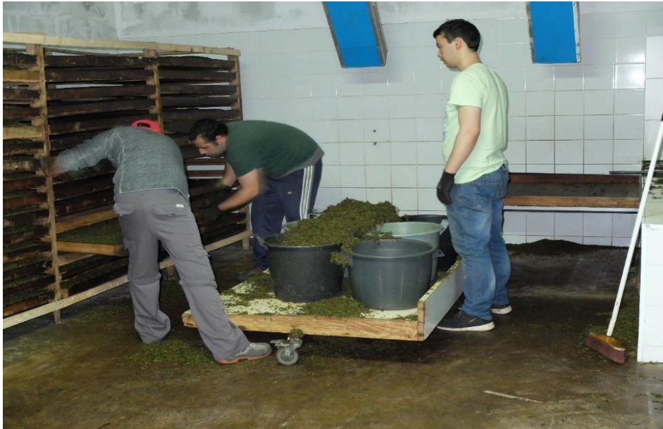
Obrázek 11: Proces oxidace černého čaje v Chá Gorreana Zdroj: autorka
