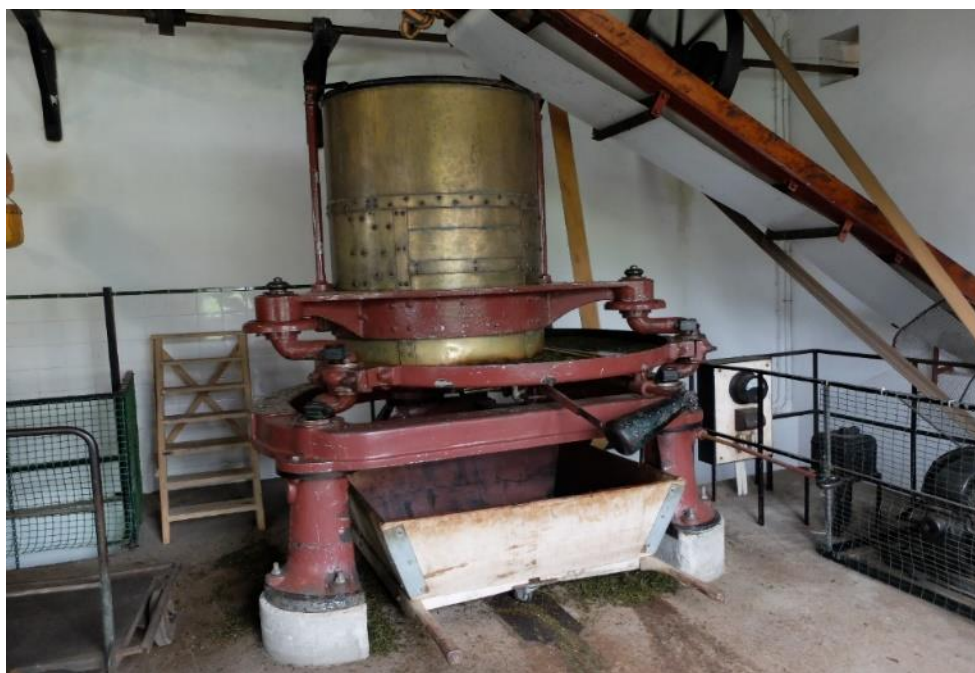
Obrázek 10: Rolování čajových lístků v Chá Gorreana Zdroj: autorka
