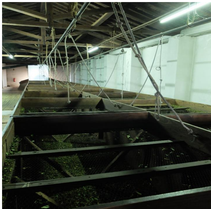
Obrázek 9: Proces zavadnutí čajových lístků v továrně Chá Gorreana Zdroj: autorka
