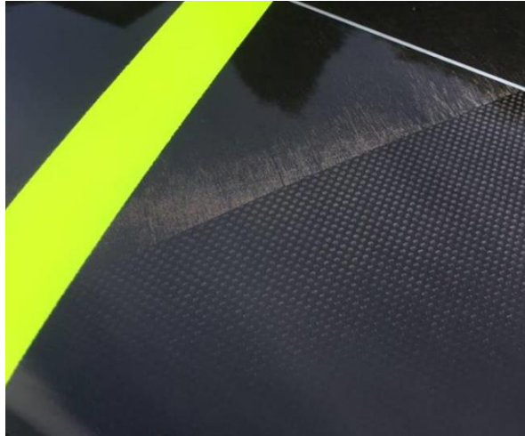
Obrázek 5: Uhlíková vlákna, část křídla modelu F5J
