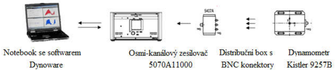
Obr. 8.4 Schéma zapojení měřící aparatury KISTLER 9272B [62].
