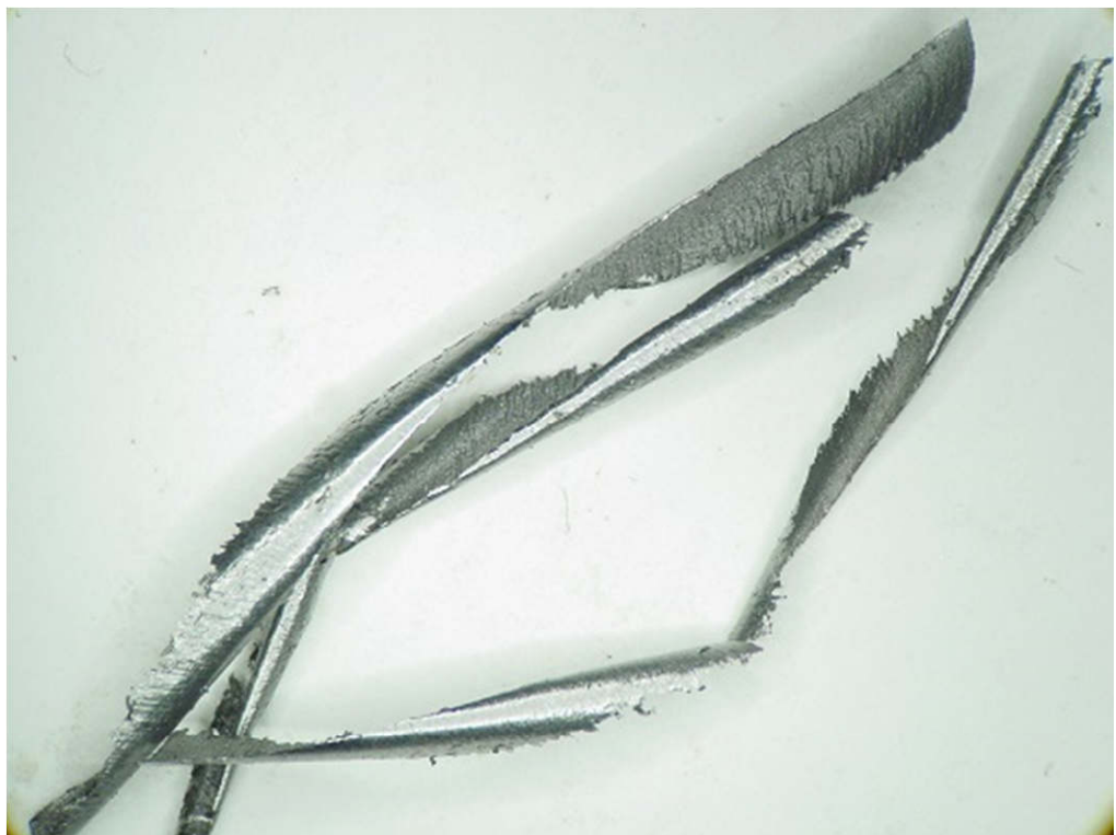
Tříska vzniklá při 50. (posledním) průjezdu nástrojem ZPS s PVD povlakem (Al,Ti)N.
