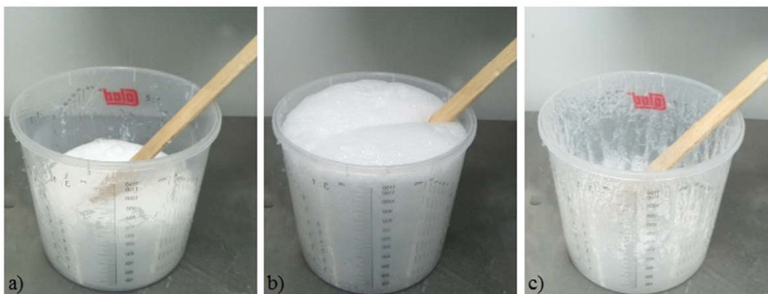
Obr. 9.7 Příprava silikonové hmoty: a-b) proces vakuování silikonové hmoty; c) připravená silikonová hmota.
