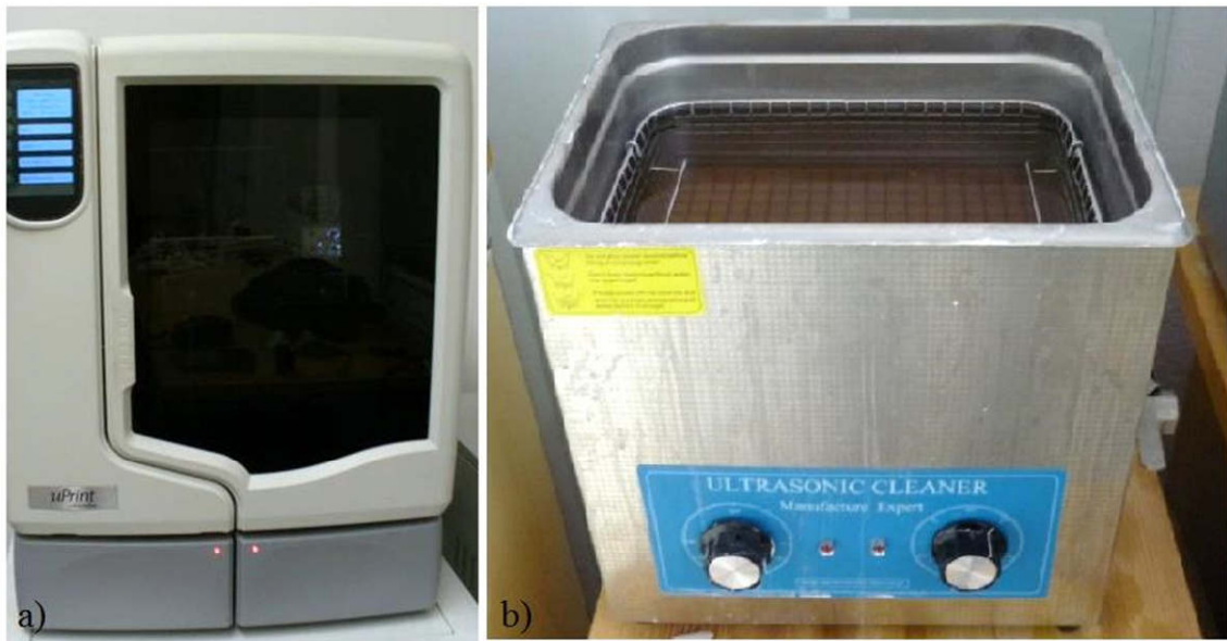
Obr. 9.2 Použité zařízení pro výrobu plastového prototypu nástroje: a) 3D tiskárna uPrint; b) ultrazvuková čistička.
