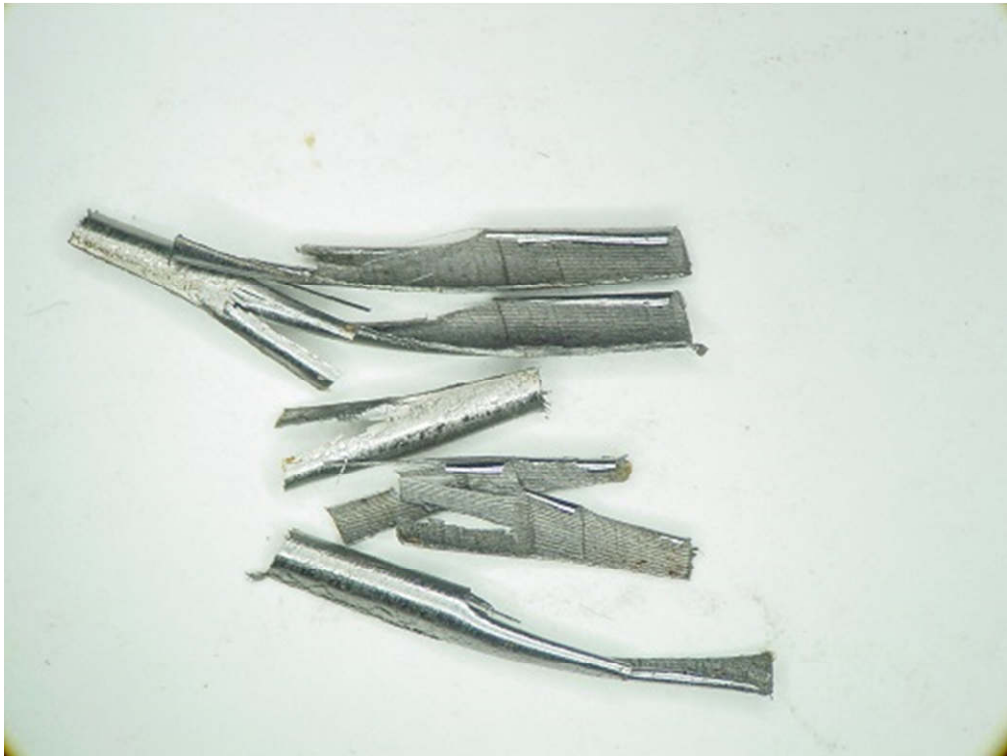
Tříska vzniklá při 1. průjezdu nástrojem RMC s PVD povlakem (Al,Ti)N.
