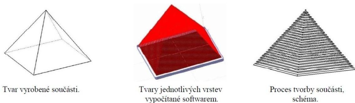
Obr. 9.1 Princip nanášení jednotlivých vrstev pomocí technologie FDM [74].
