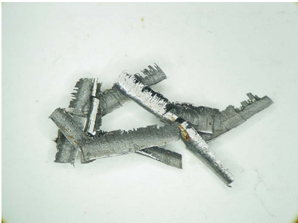
Tříska vzniklá při 50. (posledním) průjezdu nástrojem RMC s PVD povlakem (Al,Ti)N.
