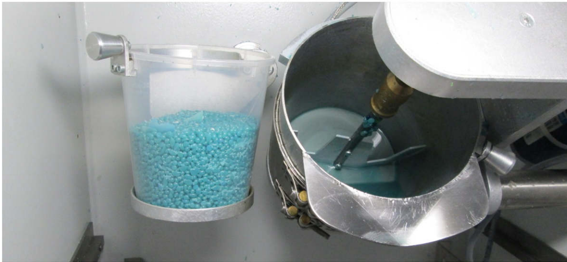
Obr. 9.10 Licí kelímek HotCup vakuového licího zařízení MK-Mini.
