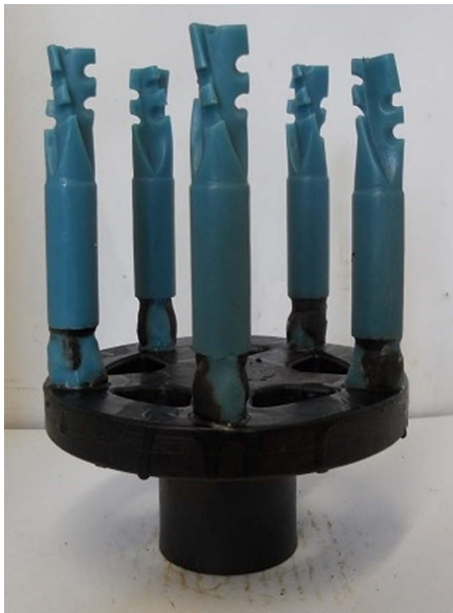
Obr. 9.13 Připravený licí stromeček připravený k obalování.
