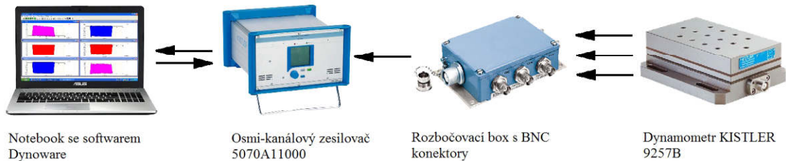
Obr. 10.5 Schéma měřicí aparatury Kistler.
