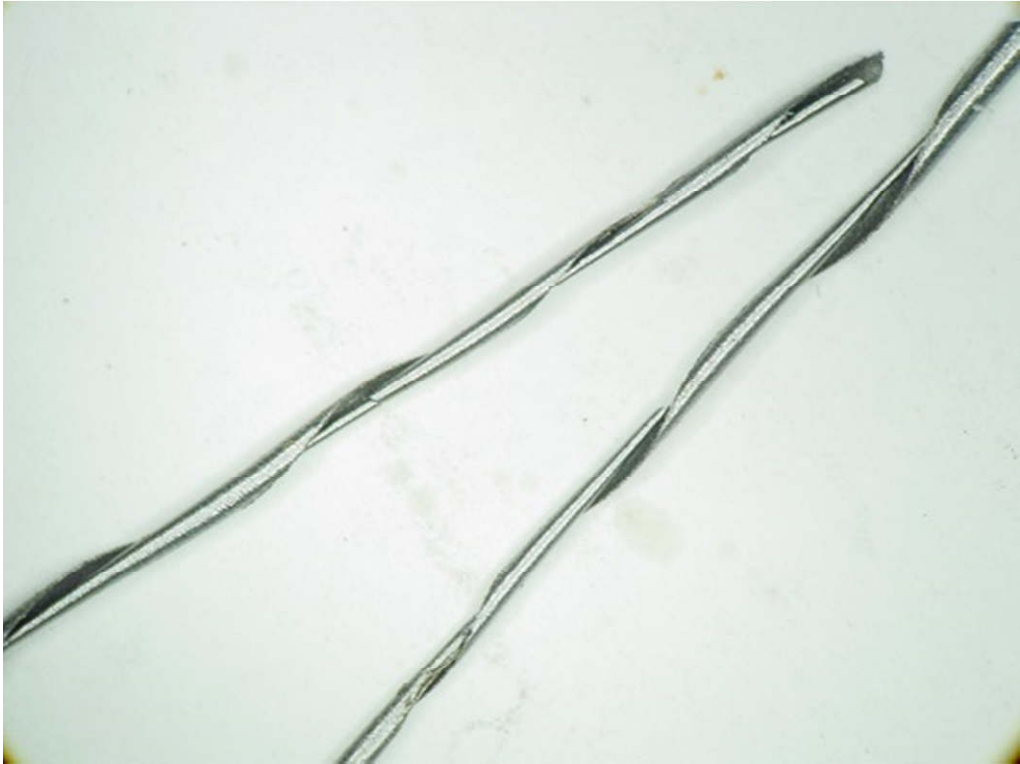
Tříska vzniklá při 1. průjezdu nástrojem ZPS s PVD povlakem (Al,Ti)N.
