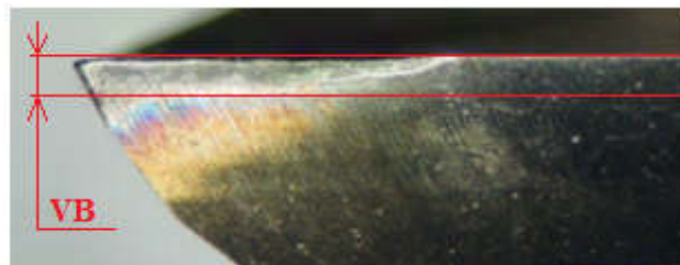
Obr. 6.3 Ukázka měření opotřebení pomocí kritéria VB – šířky fazetky na hřbetě.
