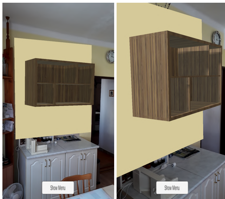
Obrázek 4.9: Pro vytvoření clony byla v případě těchto obrázků použita barva odpovídající barvě stěny. Na obrázku vlevo dochází, vzhledem k úhlu pohledu, k přesnému krytí cílové oblasti - clona nikde nepřesahuje. Vpravo je pohled z ostřejšího úhlu, kdy je vidět náznak toho, že clona již začíná zasahovat do prostoru dveří.
