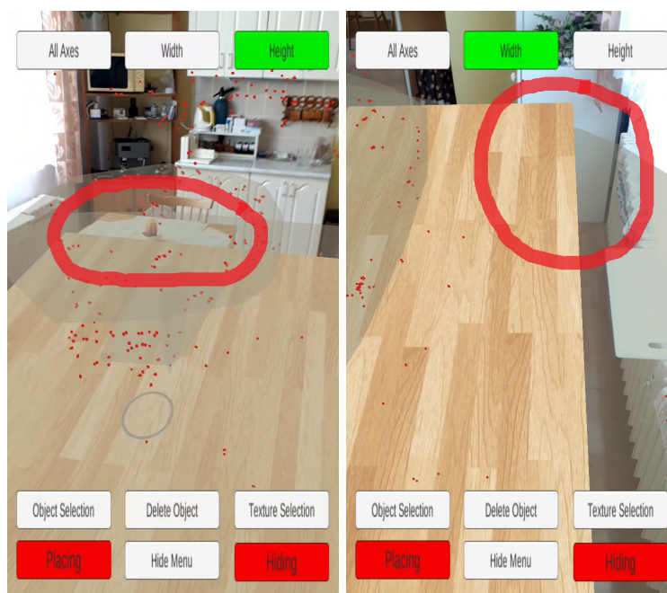
Obrázek 4.13: Obrázek vlevo zobrazuje pohled na testovací scénu z úhlu, ve kterém nedochází překrytí celého cílového objektu - červeně označená část stolu. Vpravo je pak vidět případ, kdy došlo k překrytí i dalších objektů - červeně vyznačená část bílé skříňky.
