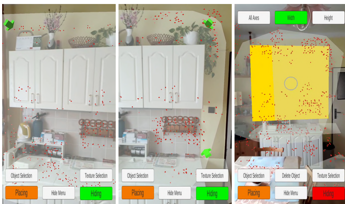
Obrázek 4.6: Na snímku vlevo byl vytvořen první bod sloužící pro vytvoření clony - označen zelenou šipkou. Na prostředním snímku byly vytvořeny další dva body. Obrázek vpravo pak znázorňuje situaci, kdy byly zadány všechny 4 potřebné body a byla vytvořena clona.
