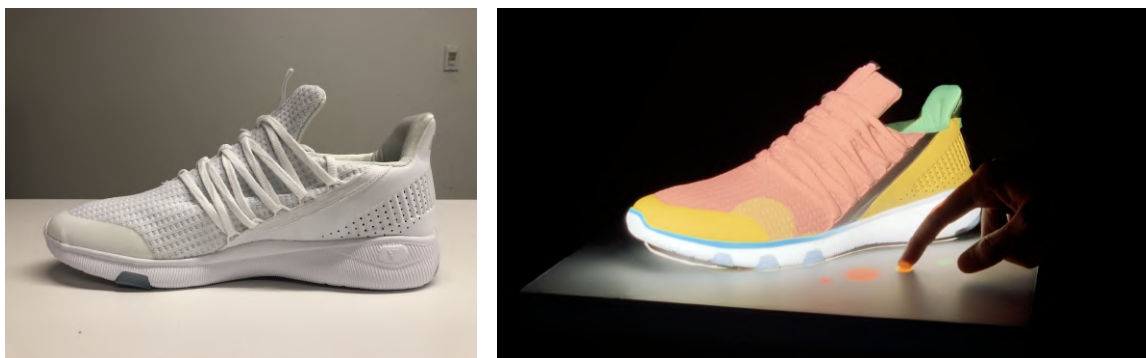
Obrázek 2.3: Vlevo skutečná podoba boty použité pro zobrazení rozšířené reality prostřednictvím projektoru. Vpravo stejná bota na níž je prováděna projekce barevného vzoru (převzato z [8]).
