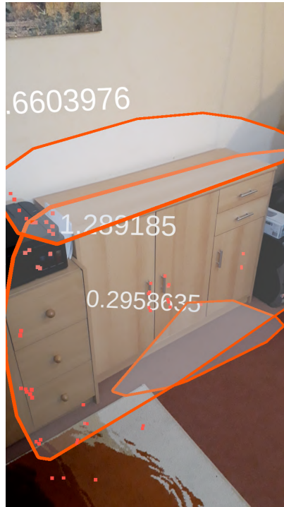
Obrázek 3.4: Snímek obrazovky aplikace zobrazující detekované roviny - oranžově ohraničené polygony. Detekované vizuálně význačné body jsou označeny červenými čtverečky.
