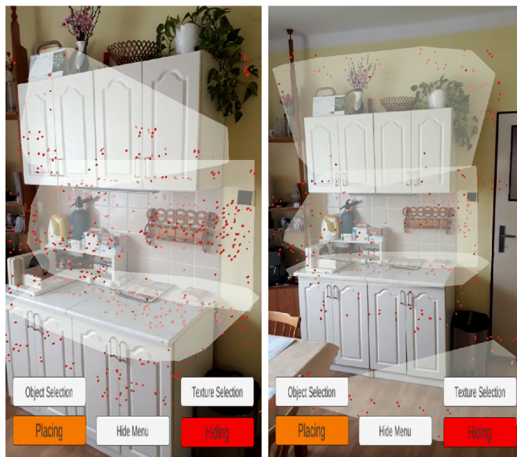
Obrázek 4.5: Dva snímky z aplikace zobrazující tři detekované roviny - zadní stěnu, přední stranu nástěnných skříněk a kuchyňskou desku - ze dvou úhlů pohledu.
