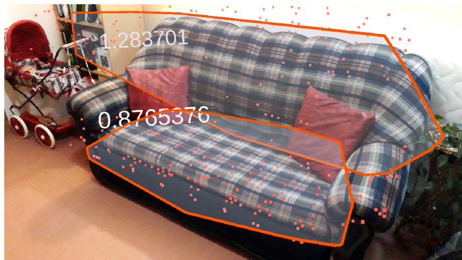
Obrázek 3.6: Snímek obrazovky aplikace zobrazující detekované roviny - oranžově ohraničené polygony. Detekované vizuálně význačné body jsou označeny červenými čtverečky.
