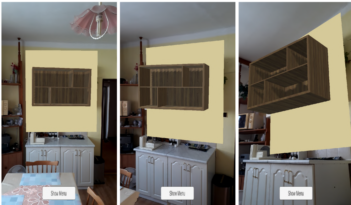
Obrázek 4.8: Pro vytvoření clony byla v případě těchto obrázků použita barva odpovídající barvě stěny. Obrázek vlevo je vzdálený pohled na celou scénu. Prostřední pohled znázorňuje pohled mírně z boku na celou scénu, ve které se virtuální skříňka nachází nad skutečnými skříňkami pod ní - je tedy na pozici nástěnných skříněk. Snímek vpravo zobrazuje scénu z nižší výšky.
