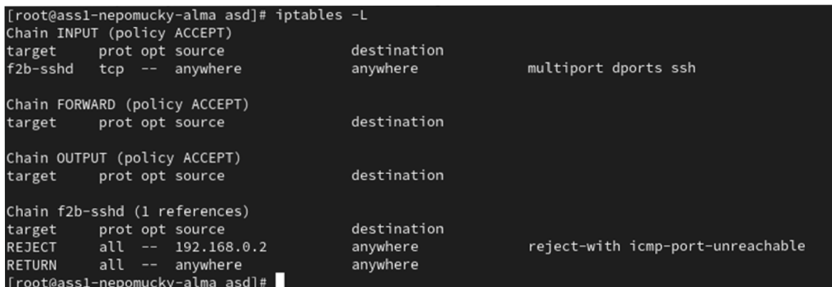
Obrázek 42 – Zablokování IP adresy v iptables Zdroj: [vlastní zpracování]
