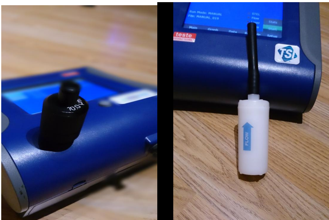
Obrázek 4. V levé části impaktor pro pro částice menší než 10 \mu\text{m} , v části pravé nulovací filtr
