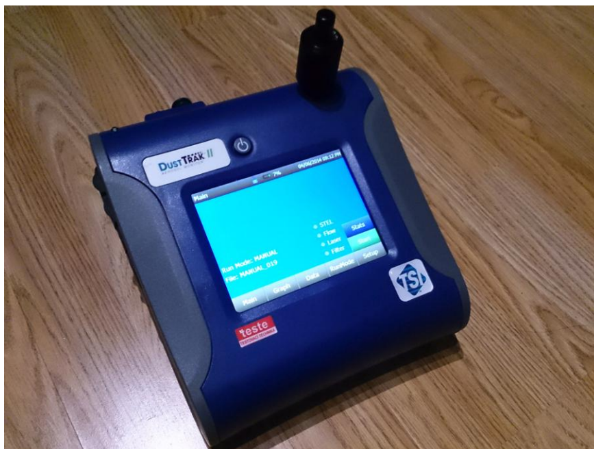
Obrázek 3. Přístroj DustTRAK 8530 s nasazeným impaktorem pro částice menší než 10\ \mu\text{m}
