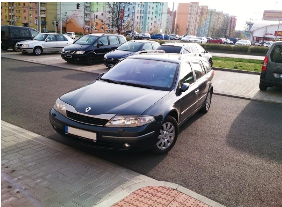
Obrázek 16. Osobní automobil kategorie M, typ Kombi. Značka Renault, model Laguna. Vznětový motor o zdvihovém objemu 1870 ccm, výkon 88 kW. Pohotovostní hmotnost 1460 kg.
