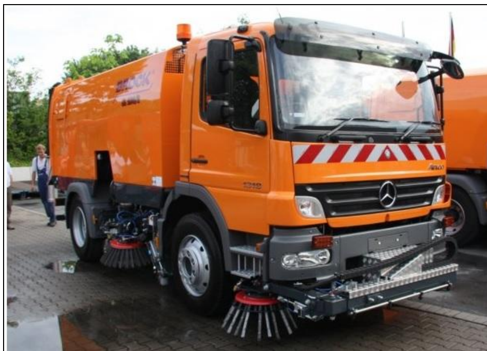
Obrázek 17. Samosběrný zametač Brock SL 200, objem zásobníku nečistot 6m 3 ,objem vodní nádrže 1200 l, zametací šířka 3000mm
