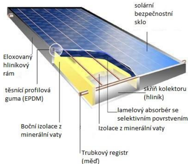
Obr. 6 Řez plochým kolektorem [27]
