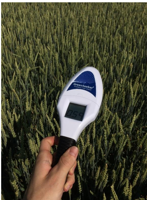
Obr. 16: Měření hodnoty NDVI, pomocí přístroje GreenSeeker (Zdroj: Autor).
