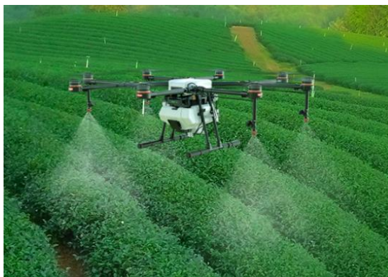
Obr. 10 : UAV DJI Agras MG-1S, využívané pro postřik plodin (Zdroj: https://www.dji.com/cz/mg-1s ).
