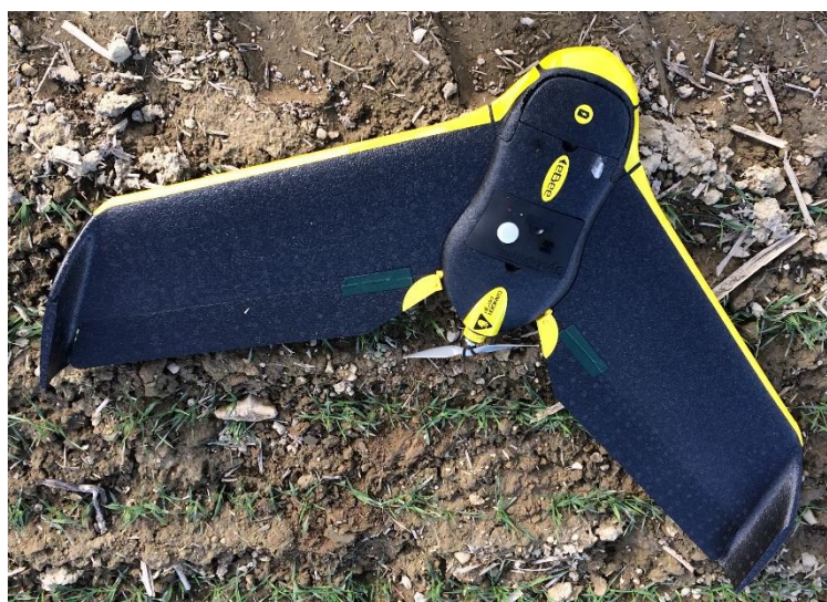
Obr. 18 : UAV křídlo SenseFly eBee, použité pro nálet lokality (Zdroj: Autor)
