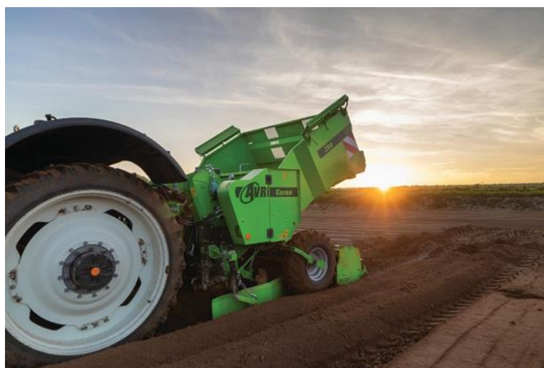
Obrázek 2.5 Nesený dvouřádkový sazeč brambor AVR Ceres 200 (vinrowe.com.au, 2023)
