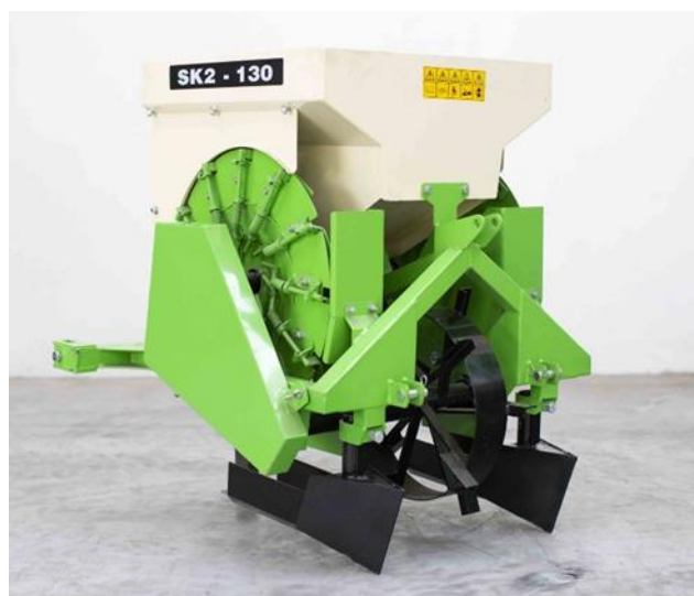
Obrázek 2.8 Dvouřádkový sazeč brambor SK2-130 bez zahrnovacích radlic s kotoučovým sázečím ústrojím s prstovými přidržovači (agroservispv.cz, 2020)
