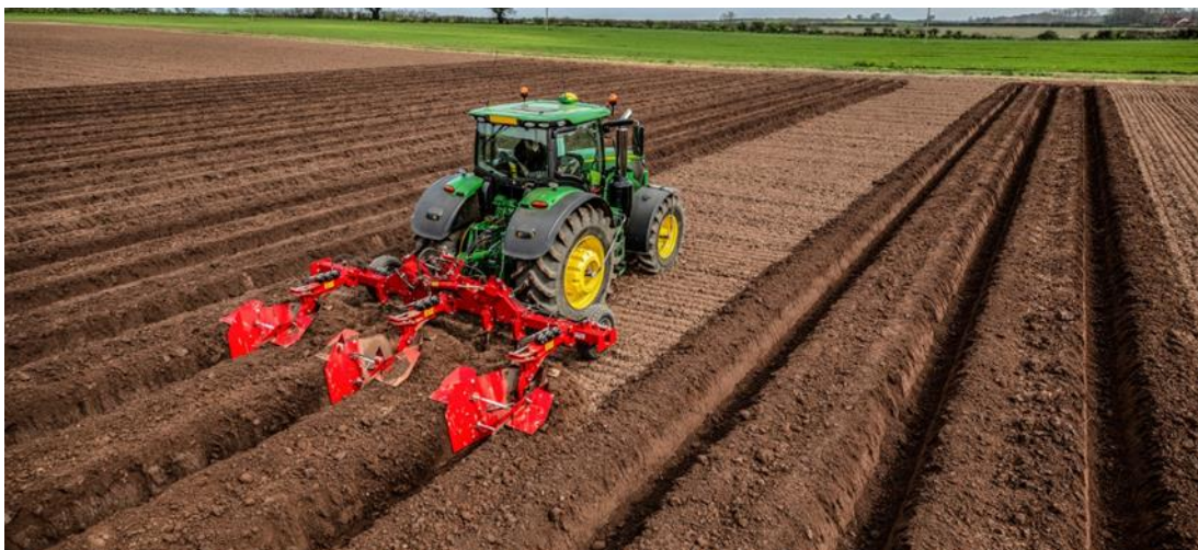
Obrázek 1.2 Třířádkový rýhovač Grimme s traktorem se satelitním naváděním (static.grimme.com, 2023)
