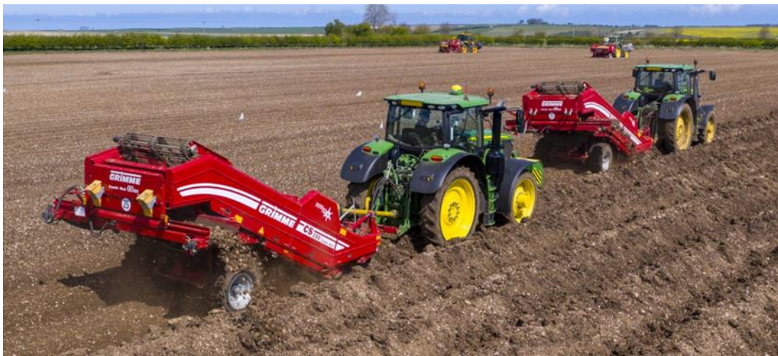
Obrázek 1.3 Dva separátory Grimme zařazené za sebou pro zvýšení efektivity práce (static.grimme.com, 2023)
