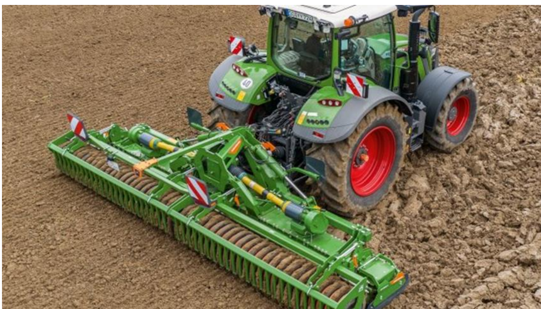
Obrázek 1.1 Rotační brány Amazone s pracovním záběrem 6 m (agroportal24h.cz, 2023)
