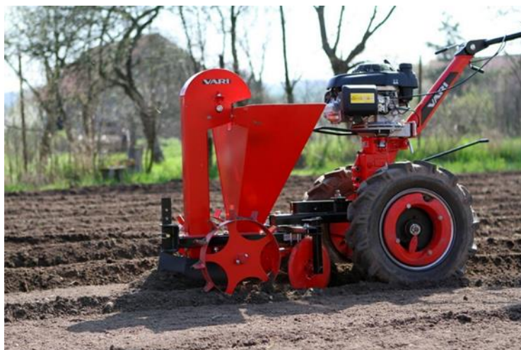
Obrázek 2.3 Jednořádkový sazeč brambor Vari SB-40 (vari.cz, 2023)
