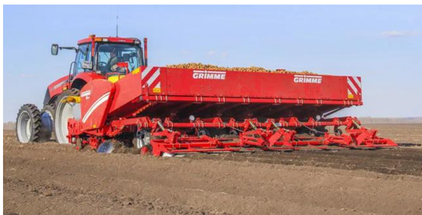
Obrázek 2.4 Tažený osmiřádkový sazeč brambor Grimme GL 860 (products.grimme.com, 2023)
