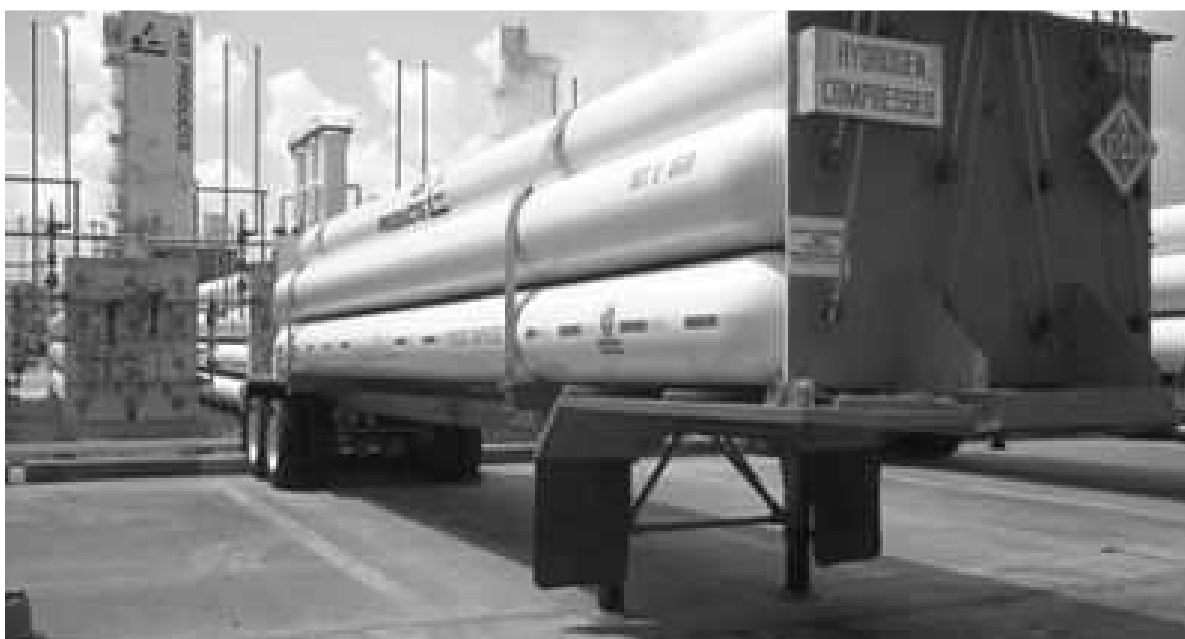
Obrázek 10: Skladování vodíku v plynném skupenství - bateriové uspořádání [43]
