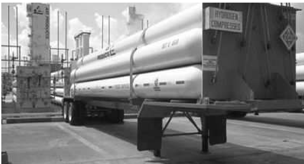
Obrázek 10: Skladování vodíku v plynném skupenství - bateriové uspořádání [43]
