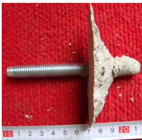
Obrázek 59 – Kotva 3, vyčištěná, hloubky 40 mm
