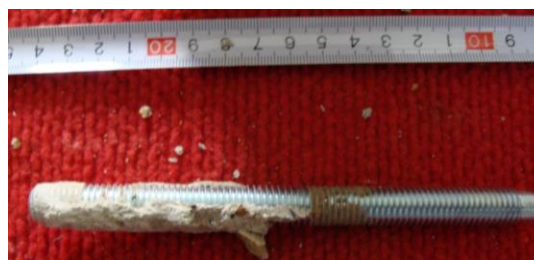
Obrázek 63 – Kotva 3, vyčištěná, hloubky 70 mm
