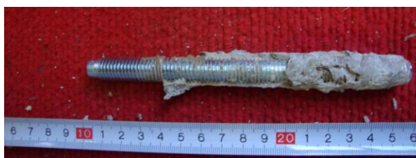
Obrázek 66 – Kotva 3, vyčištěná, hloubky 110 mm
