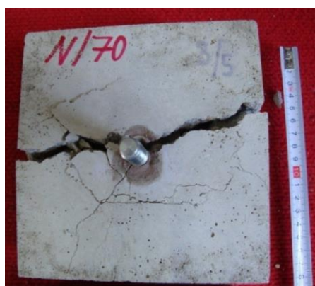
Obrázek 71 – Kotva 2, nevyčištěná, hloubky 70 mm
