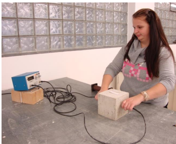
Obrázek 44 - Měření doby průchodu ultrazvukového měření pomocí přístroje TICO
