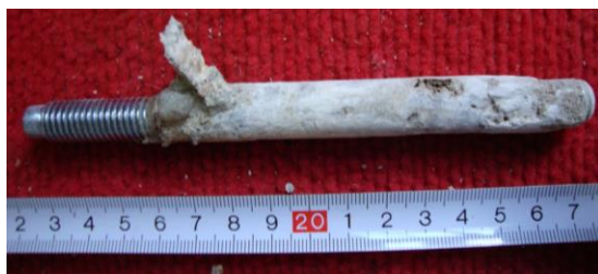
Obrázek 73 – Kotva 1, nevyčištěná, hloubky 110 mm
