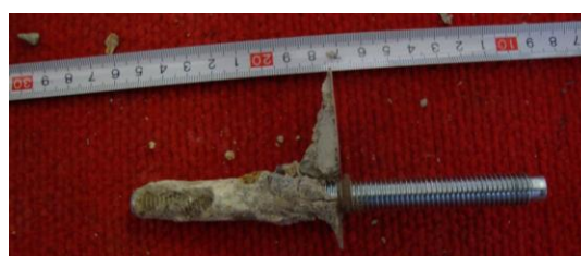
Obrázek 62 – Kotva 2, vyčištěná, hloubky 70 mm
