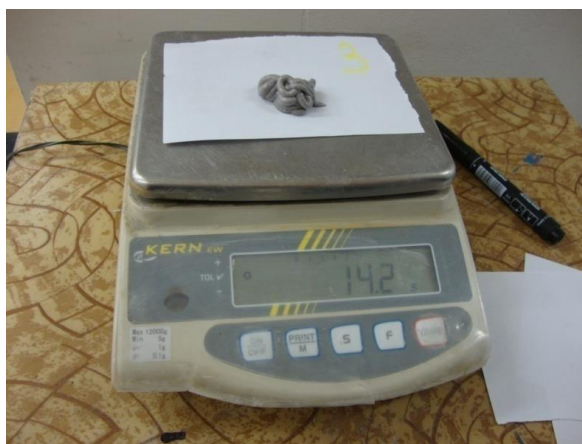
Obrázek 52 – Počáteční vytlačení lepicí hmoty
