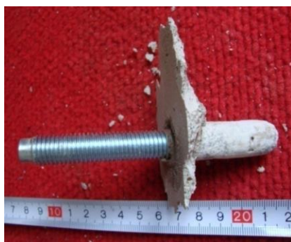
Obrázek 67 – Kotva 2, nevyčištěná, hloubky 40 mm
