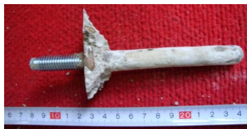
Obrázek 74 – Kotva 2, nevyčištěná, hloubky 110 mm
