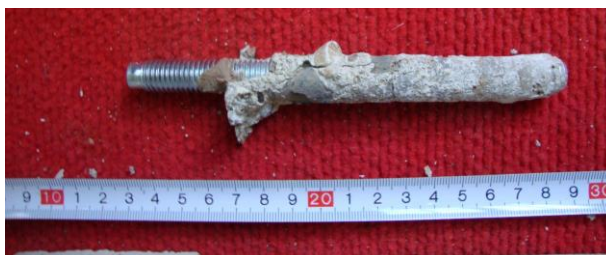
Obrázek 64 – Kotva 1, vyčištěná, hloubky 110 mm
