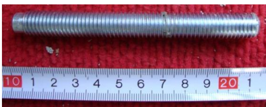
Obrázek 57 – Kotva 1, vyčištěná, hloubky 40 mm
