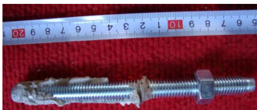
Obrázek 61 – Kotva 1, vyčištěná, hloubky 70 mm
