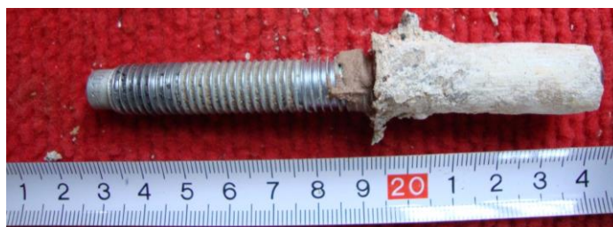
Obrázek 69 – Kotva 3, nevyčištěná, hloubky 40 mm
