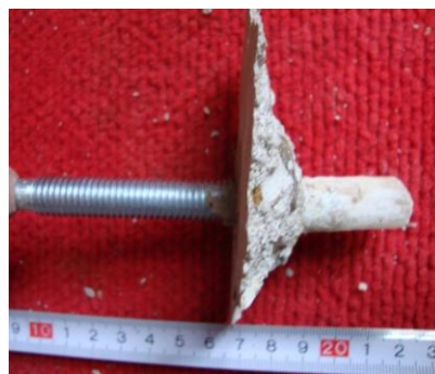
Obrázek 68 – Kotva 1, nevyčištěná, hloubky 40 mm
