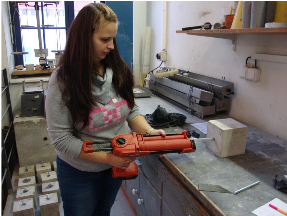
Obrázek 53 – Aplikace lepicí hmoty
