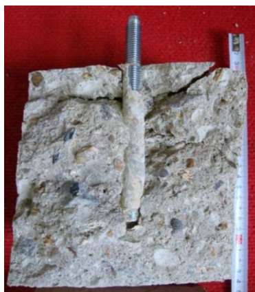
Obrázek 75 – Kotva 3, nevyčištěná, hloubky 110 mm
