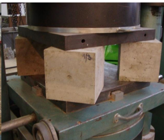
Obrázek 48 – Uchycení betonových krychlí
