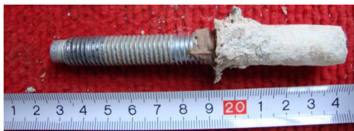
Obrázek 69 – Kotva 3, nevyčištěná, hloubky 40 mm
