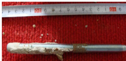
Obrázek 63 – Kotva 3, vyčištěná, hloubky 70 mm
