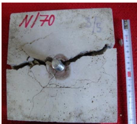
Obrázek 71 – Kotva 2, nevyčištěná, hloubky 70 mm
