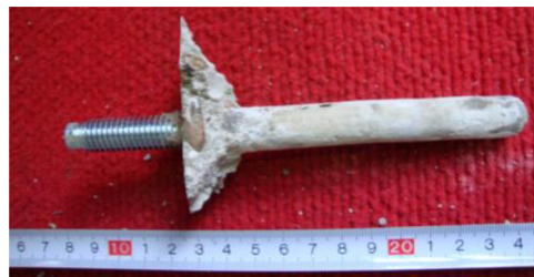
Obrázek 74 – Kotva 2, nevyčištěná, hloubky 110 mm
