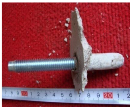
Obrázek 67 – Kotva 2, nevyčištěná, hloubky 40 mm
