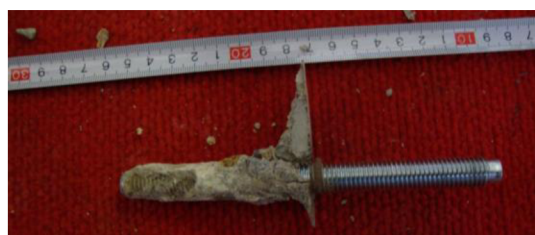
Obrázek 62 – Kotva 2, vyčištěná, hloubky 70 mm
