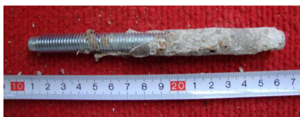
Obrázek 65 – Kotva 2, vyčištěná, hloubky 110 mm
