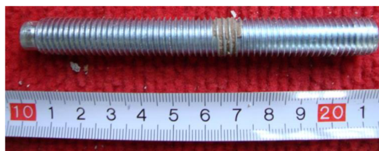
Obrázek 58 – Kotva 2, vyčištěná, hloubky 40 mm
