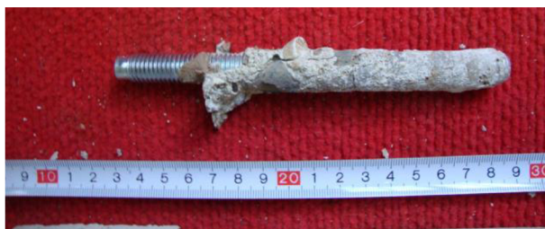
Obrázek 64 – Kotva 1, vyčištěná, hloubky 110 mm
