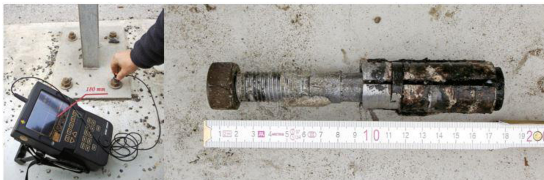
Obr. 31 – Měření délky kotvení u svodidel
