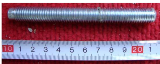
Obrázek 57 – Kotva 1, vyčištěná, hloubky 40 mm
