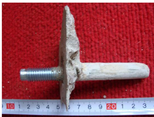
Obrázek 72 – Kotva 3, nevyčištěná, hloubky 70 mm
