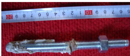
Obrázek 61 – Kotva 1, vyčištěná, hloubky 70 mm
