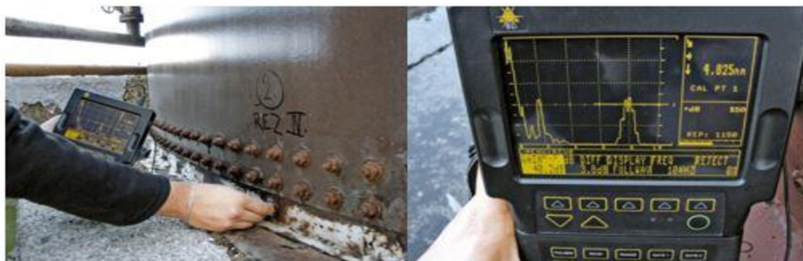
Obrázek 18 – Měření tloušťky patních plechů
