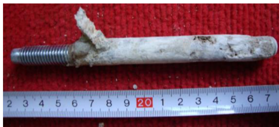
Obrázek 73 – Kotva 1, nevyčištěná, hloubky 110 mm
