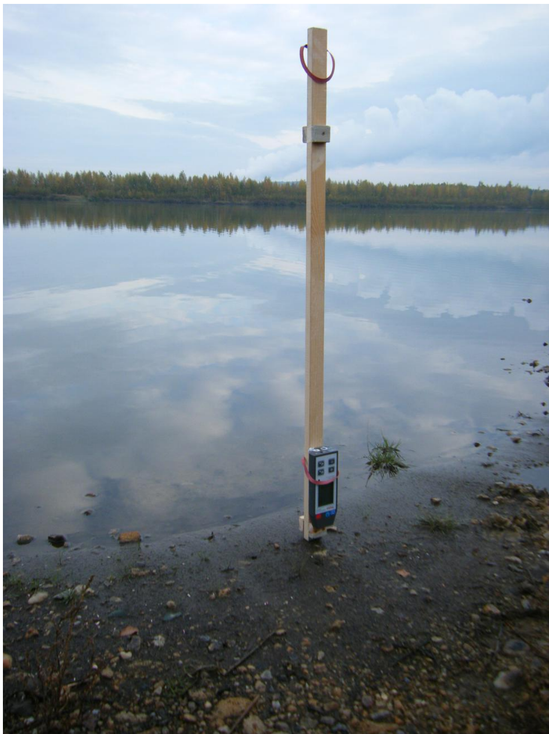
Obrázek 17 - Měření příkonu dávkového ekvivalentu záření gama pomocí radiometru FH 40G-L10 (Eberline) ve výšce 0,05 metru.
