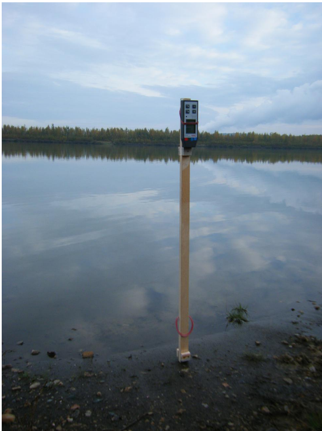
Obrázek 18 - Měření příkonu dávkového ekvivalentu záření gama pomocí radiometru FH 40G-L10 (Eberline) ve výšce 1 metr
