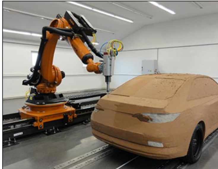
Obr. 1 Robot při frézování prototypu automobilu [3]
