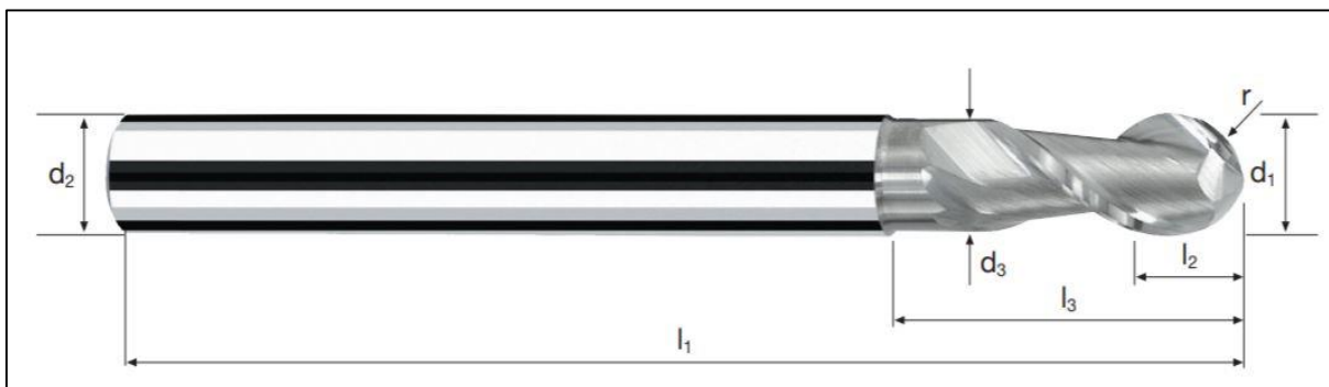
Obr. 27 Rozměry kulové frézy Fraisa C5292391 [13]
