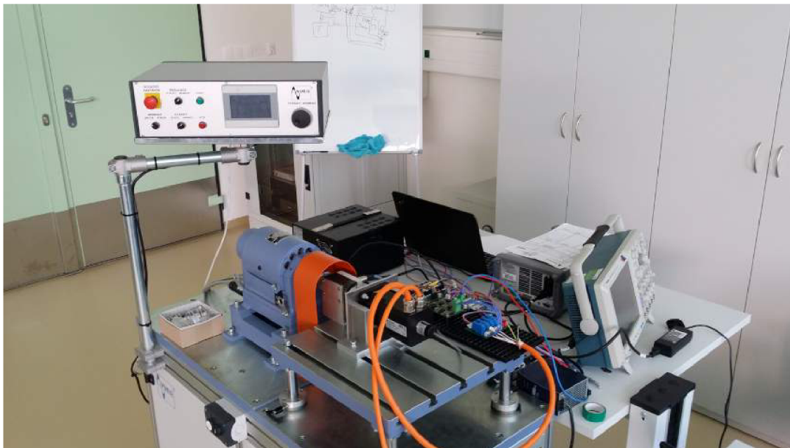
Obr. 37 : Porovnání modelu s reálným motorem – fotografie pracoviště
