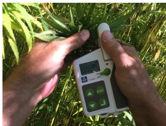
Obr. č. 26.: Měření obsahu chlorofylu v listech pomocí N-Testeru (Foto: Autor)
