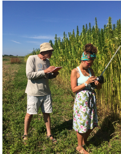
Obr. č. 28.: Měření LAI porostu konopí SunScanem (Foto: Autor)
