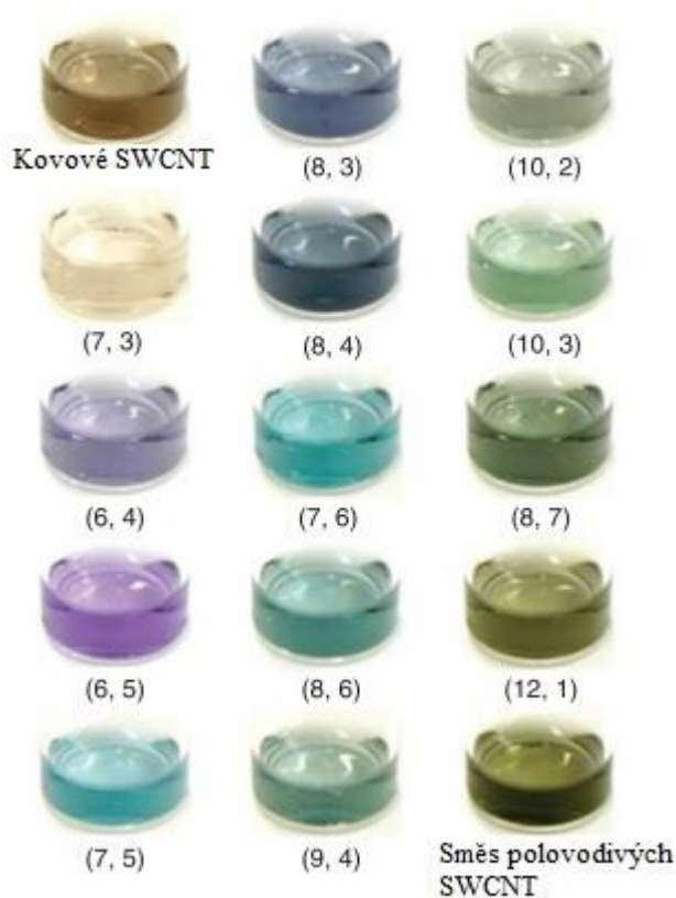
Obr.2.2.3-3: SWCNT s různými chirálními indexy dispergované ve vodném roztoku s přídavkem dodecyl sulfátu sodného (SDS) vykazují odlišnou barevnost. Převzato z ref.[40].
