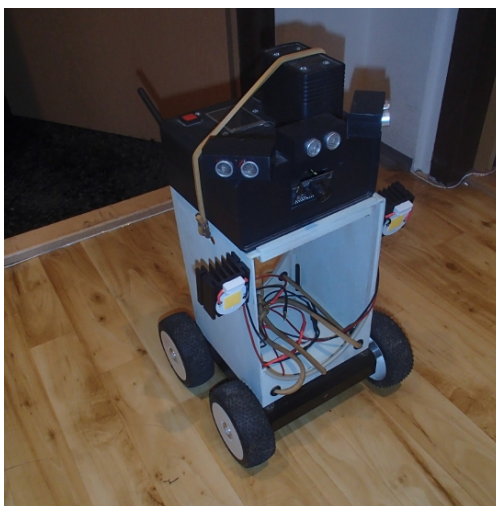
Obrázek 1: čtyřkolový diferenciální podvozek ARBot
