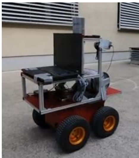
Obrázek 2: čtyřkolový diferenciální podvozek Robo@Fit
