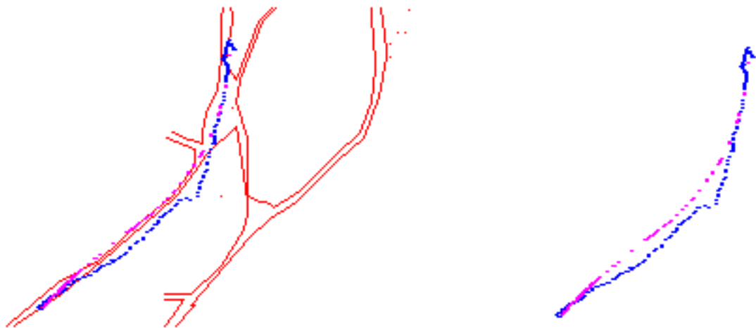
Obrázek 17: lokalizace pomocí GPS (modrá), lokalizace pomocí odometrie (magenta)
