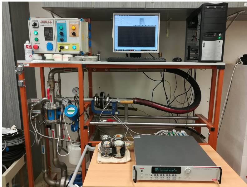
Obrázek 6.6: Finální prototyp průtokoměru a připojenými hlavními elektrodami ze skleného karbonu
