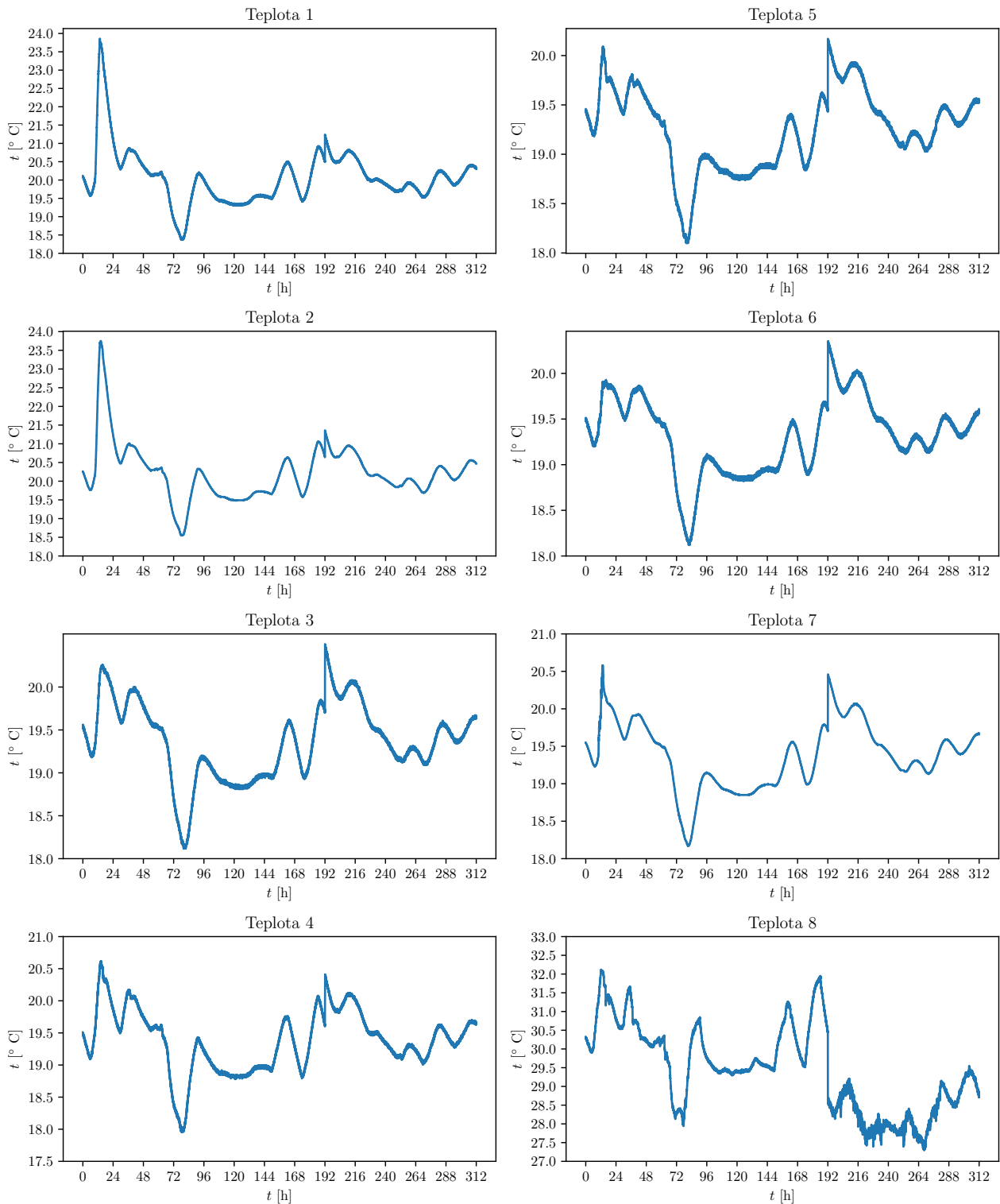
Obrázek 3.3: Průběh teplot na osmi místech obráběcího stroje
