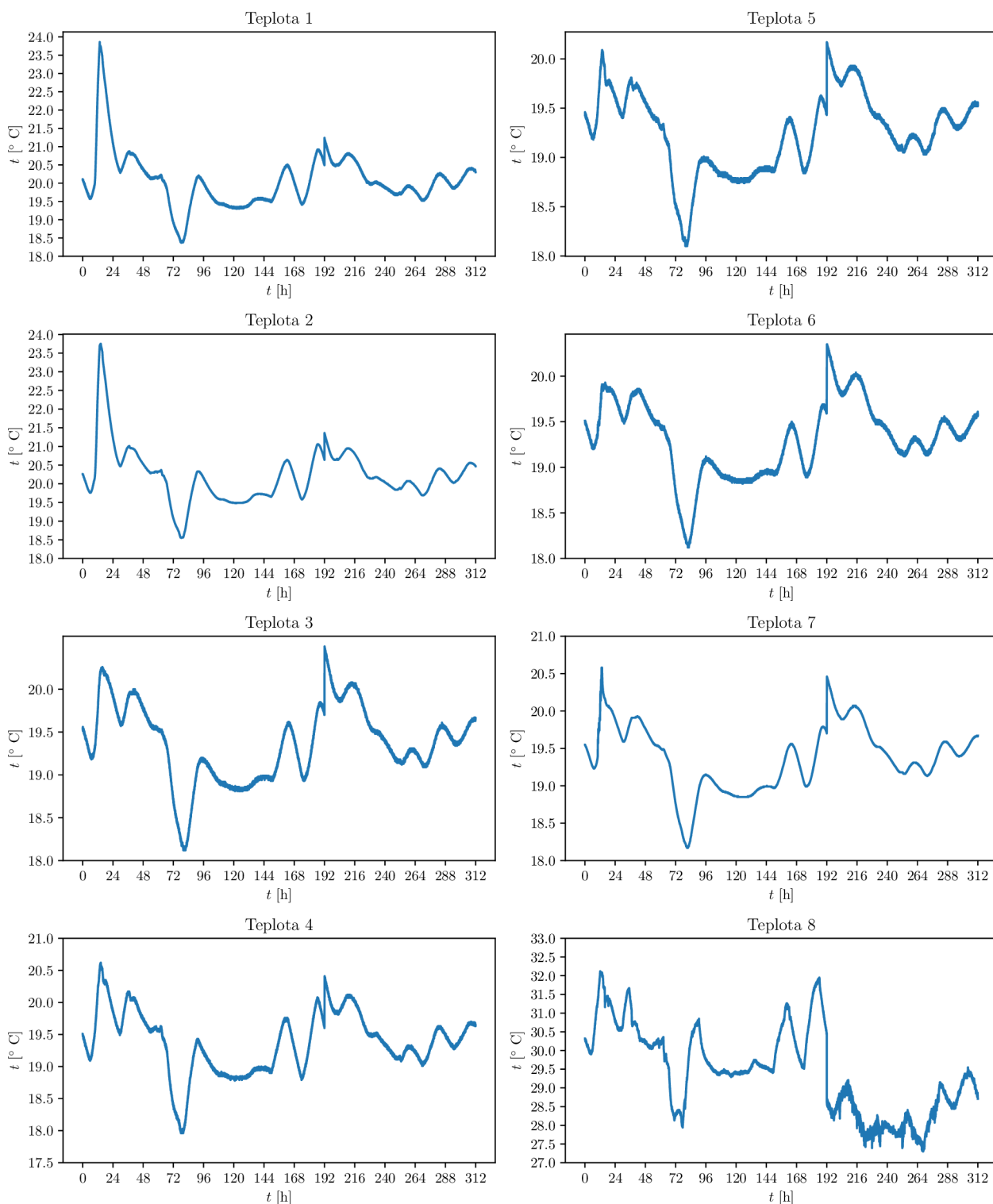
Obrázek 3.3: Průběh teplot na osmi místech obráběcího stroje
