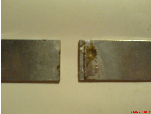
Obrázek 4: Roztrfžený vzorek s p eplátováním 2,5 mm
