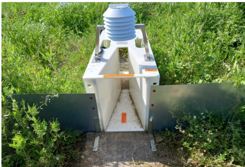
Obr. 3 - detail Parshallova žlabu (vlastní foto 5/2023)
