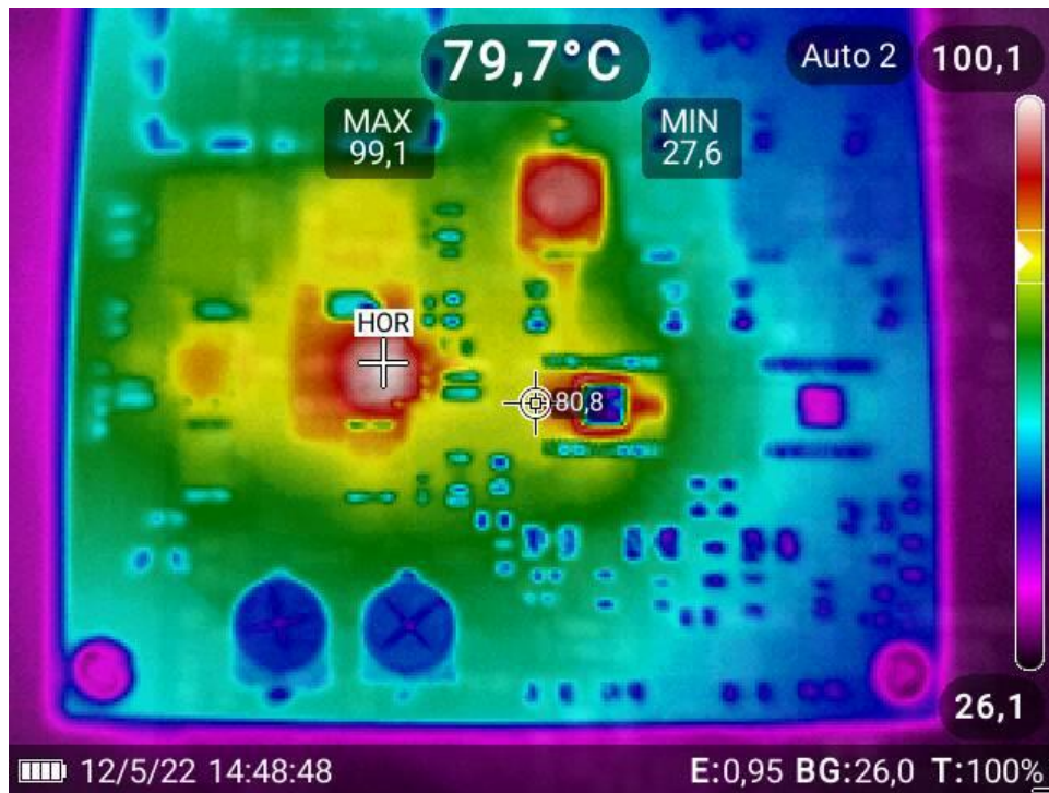
Obrázek 2.12 Detail zahříváného místa zvyšujícího měniče před kalibrací a úpravě hodnoty registru CHx_ISLOPE
