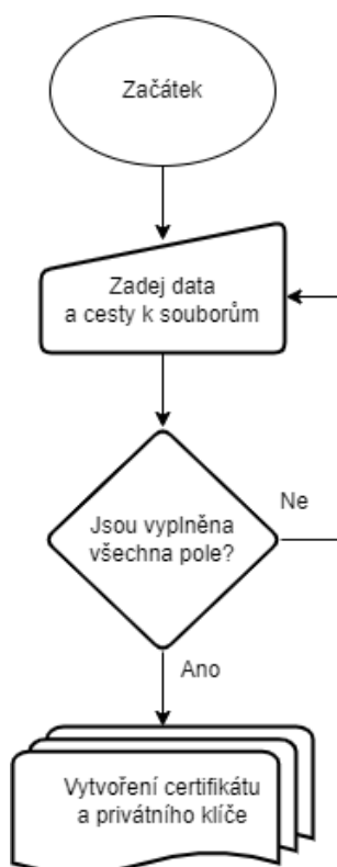
Obrázek 2.17: Vývojový diagram vytvoření self-signed certifikátu a privátního klíče.
