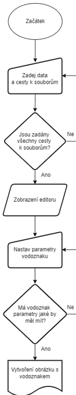
Obrázek 2.15: Vývojový diagram části aplikace se vkládáním vodoznaku.
