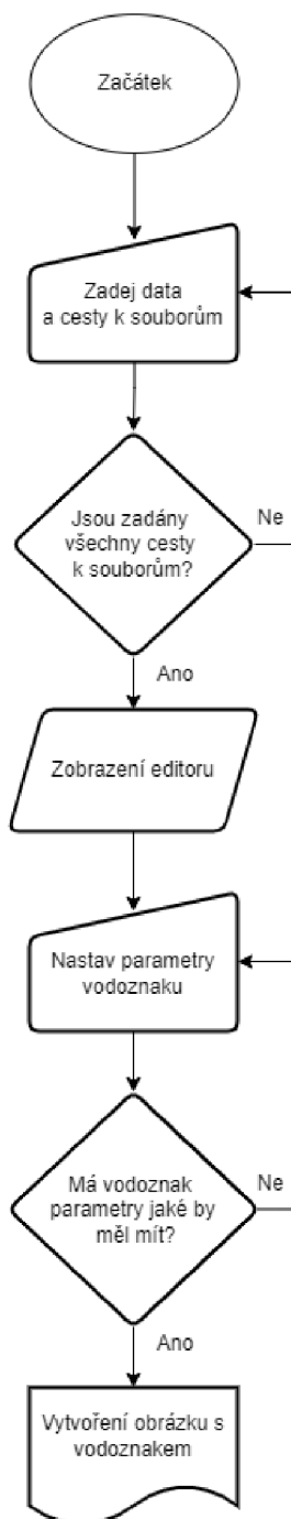
Obrázek 2.15: Vývojový diagram části aplikace se vkládáním vodoznaku.
