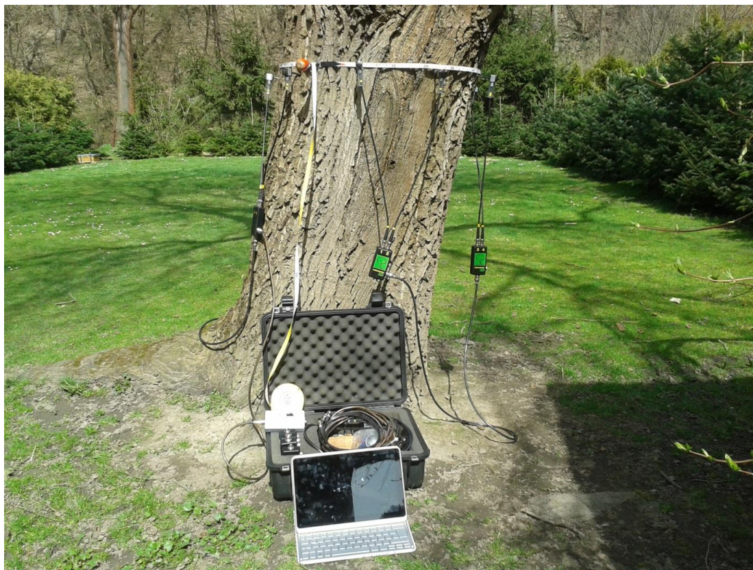
Obr. 5 Ilustrační ukázka instalace přístroje Fakopp.
