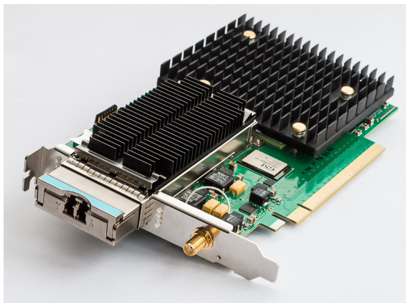
Obr. 2.5: Sieťová karta COMBO-100G. Zdroj: galéria kariet projektu Liberouter [19].
