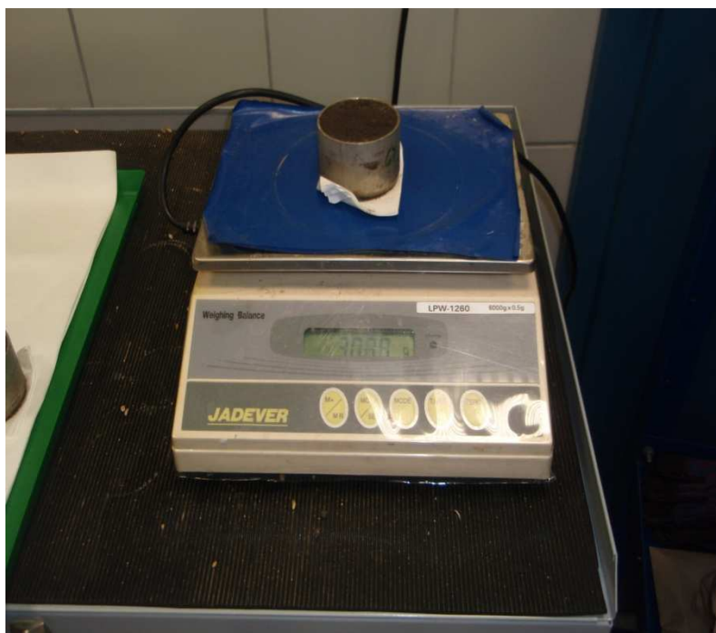
Obr. 23: Vážení odebraného vzorku půdy (foto: autor)
