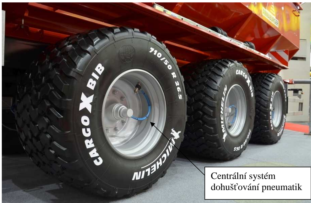
Obr. 9: Centrální systém dohušťování pneumatik u podvozku Annaburger (www.danhel.cz, 2015)
