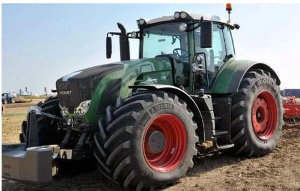
Obr. 7: Traktor Fendt s nízkotlakými pneumatikami Michelin Axiobib (www.michelin.de, 2010)
