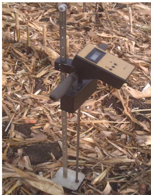
Obr. 14: Měření penetrometrického odporu půdy (foto: autor)
