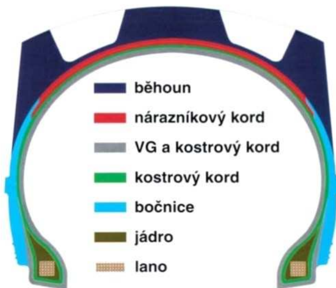
Obr. 5: Řez pláštěm pneumatiky (Mikulič, 2004)
