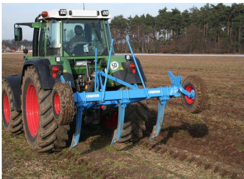
Obr. 4: Traktor s kypřičem Lemken Labrador ( www.lemken.com , 2014)
