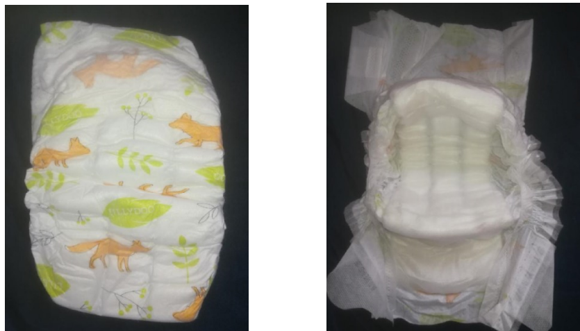
Obr. 18: Plena – vzorek č. 2, 18a – pohled na plenu ve složeném stavu, 18b – pohled na plenu v rozloženém stavu s patrnými odvodovými kanálky.
