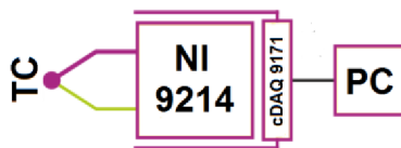
Obr. 4-7 – schéma měření teplot s osazeným termočlánkem
