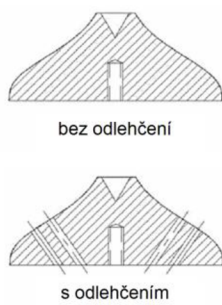
Obr. 2-9 – profilovaná kuželka bez odlehčení a s odlehčením [35]
