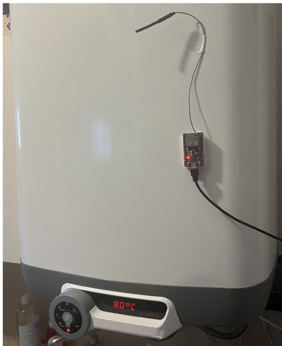
Obr. 5.3: Bojler s mikrokontrolérom ESP32.
