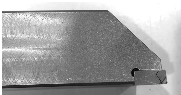
Obr. 54 Lom břitu, cermet SC8.
