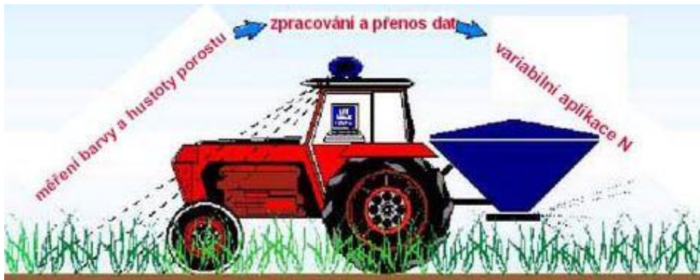
Obrázok 4 Ukážka princípu fungovania N senzoru
